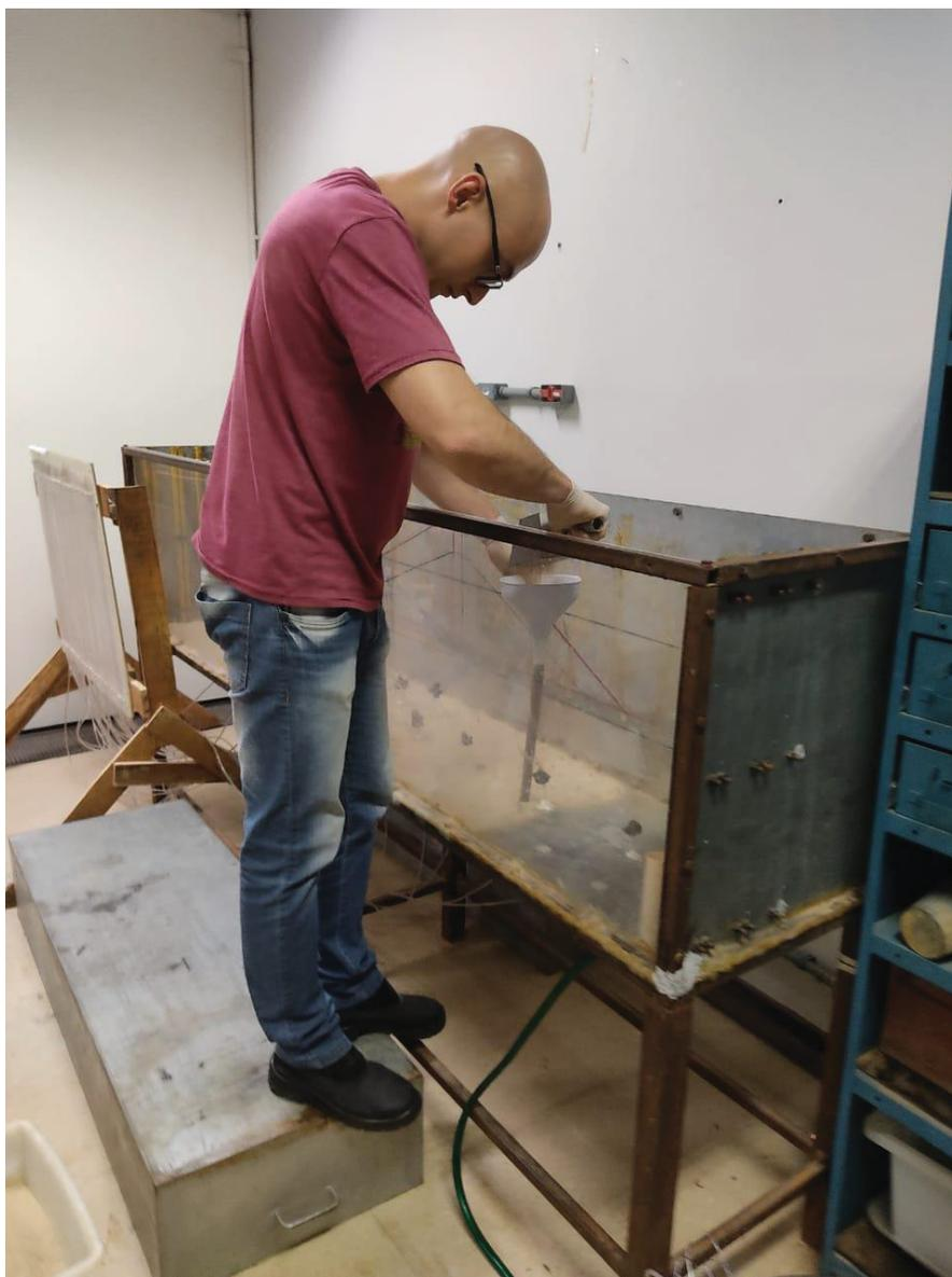
FIGURA 97 - CONSTRUÇÃO MANUAL DO DRENO HORIZONTAL E DA GBR-P
