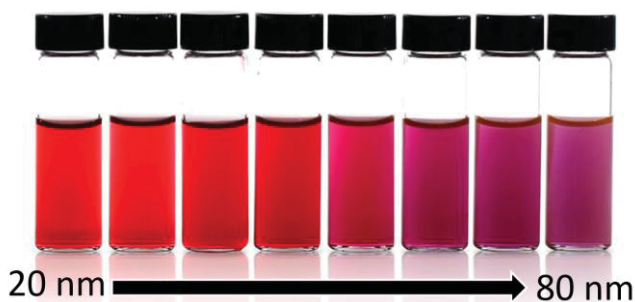
FIGURA 6: EXEMPLO DE COMO A VARIAÇÃO DE TAMANHO DAS NANOPARTÍCULAS DE OURO AFETA A ABSORÇÃO E EMISSÃO DE LUZ, LEVANDO À UMA MUDANÇA NA COLORAÇÃO DA SOLUÇÃO.
