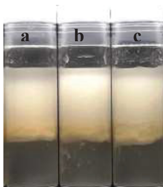
FIGURA 31: ASPECTO VISUAL DAS EMULSÕES APÓS 24 h DE PREPARO COM UMA MISTURA DA FASE OLEOSA ( \Phi_o=0,5 ), FASE AQUOSA ( \Phi_w=0,5 ) E 0,5% DE PARTÍCULAS DE S-K/SO 4 . PROCESSO DE AGITAÇÃO: (a) SONICAÇÃO, (b) MANUAL E (c) VÓRTEX POR 1 min.
