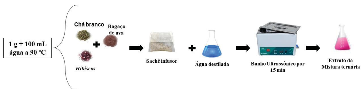
FIGURA 3.2 – Extração dos compostos bioativos da mistura ternária
