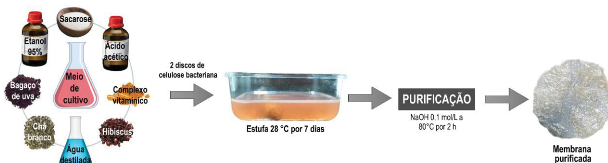
FIGURA 3.1 – Esquemática da produção da membrana de celulose bacteriana (biossorvente)
