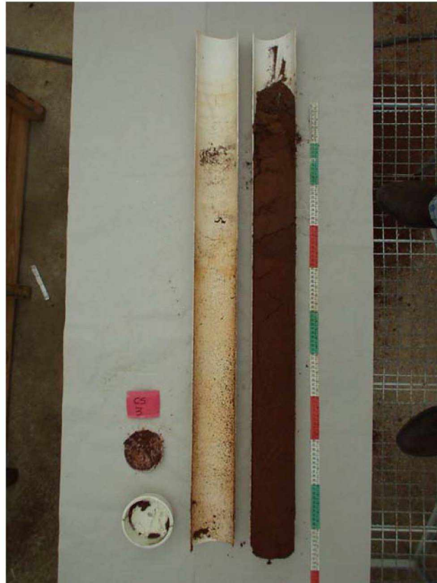
FIGURA 06 - DETALHE DO CORTE LONGITUDINAL DA COLUNA E DAS PROFUNDIDADES AMOSTRAIS
