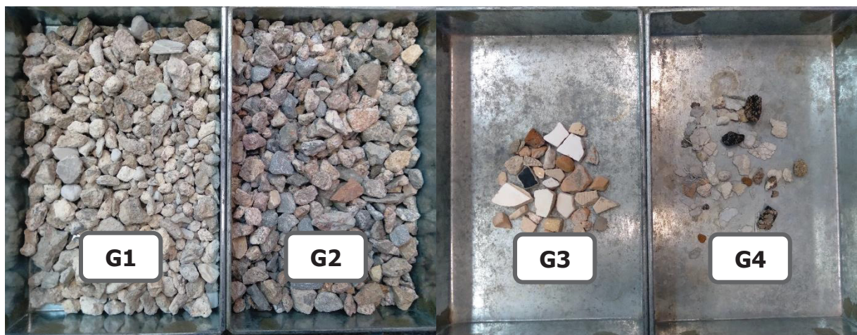
Figura 20 – Grupo de fragmentos do agregado de RCD após separação manual
