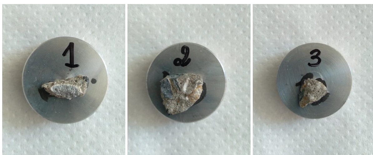
Figura 26 – Amostras preparadas para o ensaio de MEV. (a) CAA-1. (b) CAA-2. (c) CAA-3
