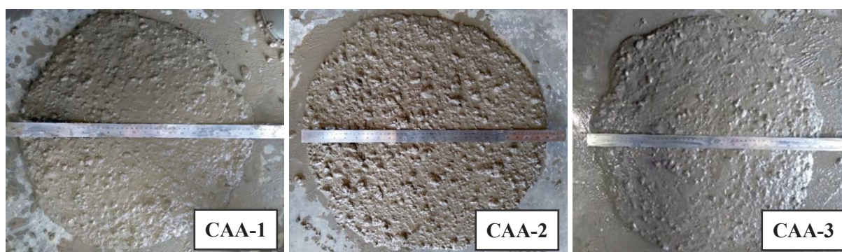
Figura 29 – Aspecto visual dos concretos após ensaio de slump-flow .
