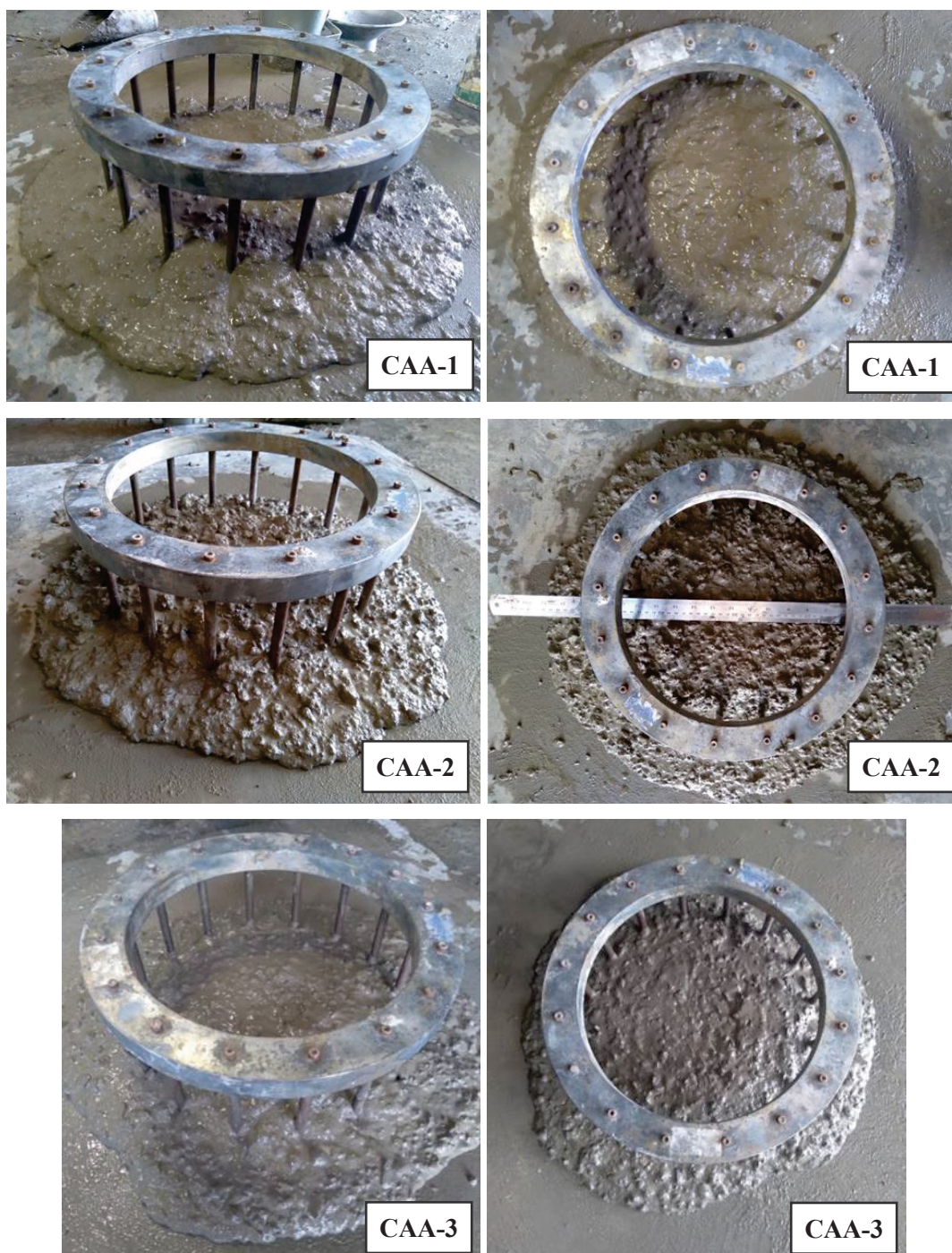
Figura 33 – Comportamento dos concretos no ensaio de Anel J.
