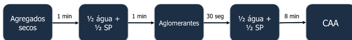
Figura 25 – Sequência de mistura dos materiais para produção do CAA
