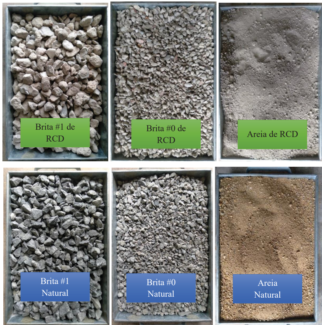
Figura 16 – Agregados naturais e agregados reciclados utilizados para a produção dos concretos
