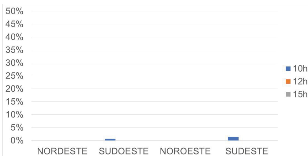
GRÁFICO 4 – PORCENTAGEM DE SOMBREAMENTO DAS FACHADAS EM CADA ORIENTAÇÃO NAS TORRES DURANTE O VERÃO NA SIMULAÇÃO 1
