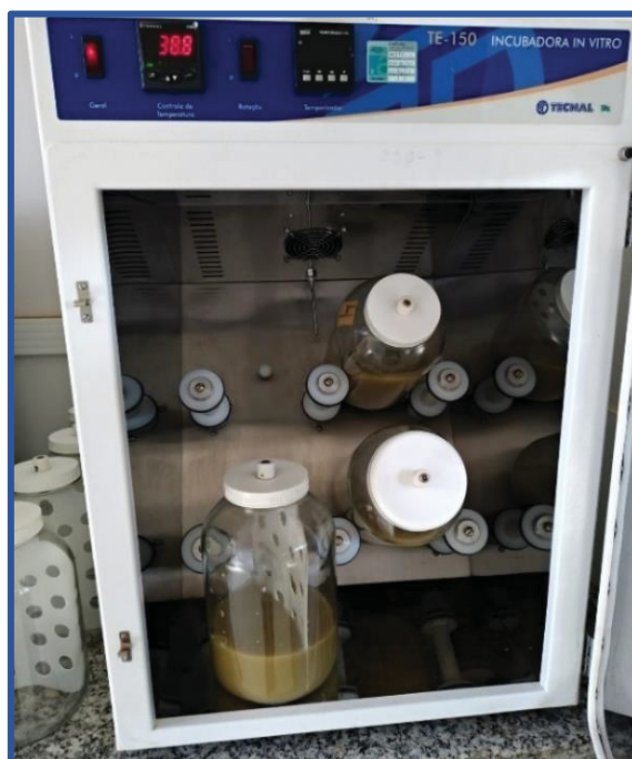
Figura 14. Imagem da incubadora in vitro Dayse TE-150 aberta mostrando os 3 jarros utilizados para incubação dos saquinhos contendo as cápsulas em líquido ruminal.
