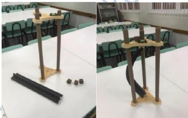
Figura 7. Modelo didático para o estudo de momento de inércia em pilares sujeitos ao esforço de compressão simples, o qual é aplicado no centro geométrico da seção do pilar para visualização da direção de menor resistência da peça.
