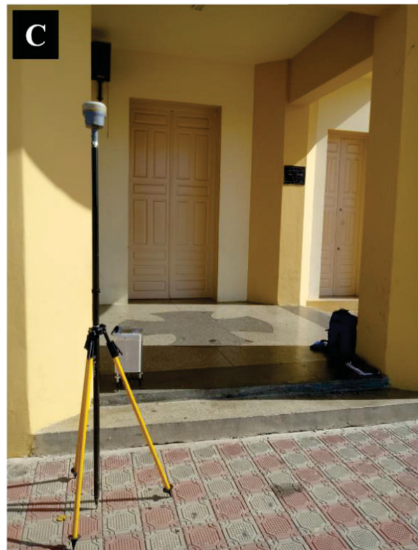
FIGURA 6 - Bases Gravimétricas utilizadas no projeto em questão. A) Base Gravimétrica da Estação de Campos Sales “B”, de responsabilidade do ON, B) Base Gravimétrica de Apoio para a área I, em São Julião, e C) Base Gravimétrica de Apoio para a área II, em Pio IX.
