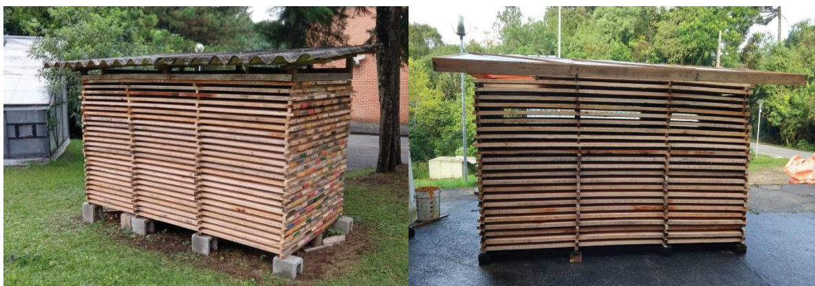
FIGURA 4.3 – PILHAS DE SECAGEM AO AR DA MADEIRA SERRADA DE Eucalyptus
