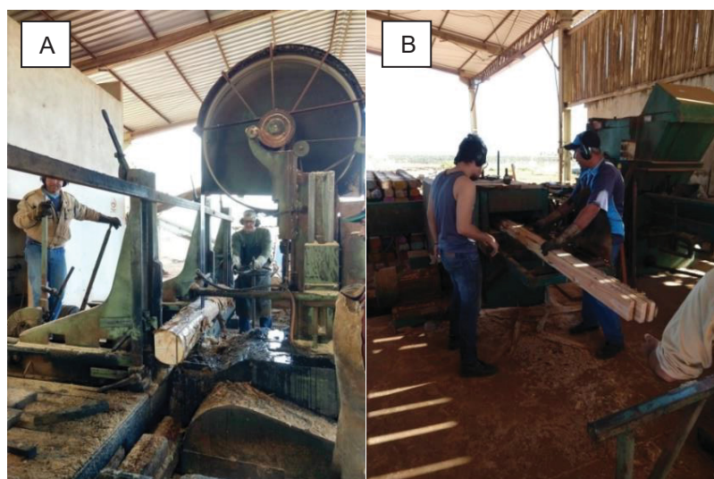
FIGURA 4.2 – MAQUINÁRIO UTILIZADA NO DESDOBRO DA MADEIRA. A – SERRA DE FITA SIMPLES; E B – SERRA CIRCULAR MÚLTIPLA
