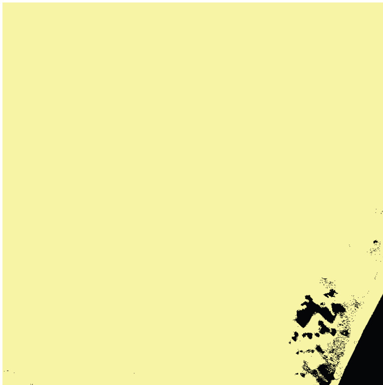
Figura 17 - Imagem binária do arquivo do MDE SRTM de resolução de 30 metros, visualizada no QGIS, onde os pixels em cor amarela têm valor 1 e os pixels em cor preta têm valor 0. Fonte: O autor (2022).
