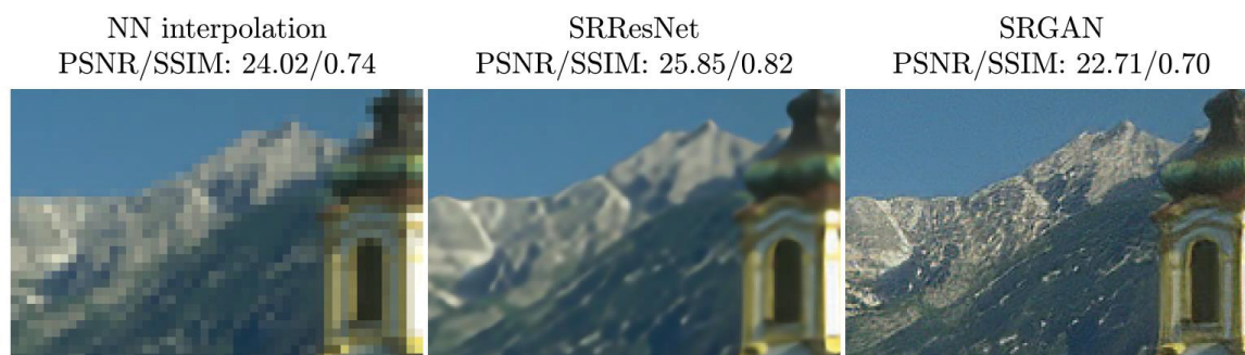
Figura 1 - Inconsistência entre os valores da medida de distorção PSNR e SSIM e da qualidade perceptiva dos métodos de super-resolução SRGAN (Super-resolution GAN), SRResNet (Super-resolution Residual neural network) e NN interpolation (interpolação pelo vizinho mais próximo), onde verifica-se um desacordo entre a análise visual de cada uma das imagens em relação aos valores obtidos das métricas utilizadas em suas avaliações (PSNR e SSIM).
