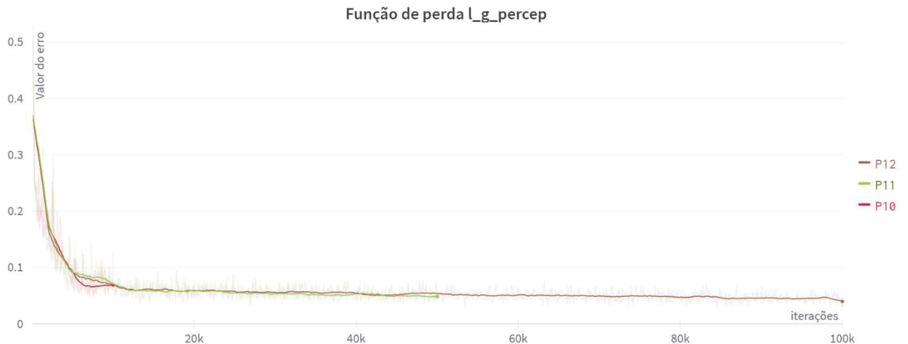
Figura 143 - Variação dos valores apresentados pelas funções de perda l_g\_percep de cada um dos processamentos DEM-ESRGAN executados (P10, P11 e P12) em função da progressão das épocas dos mesmos (onde k equivale a 1.000)
