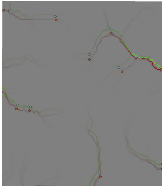
Figura 89 - Levantamento dos 10 pontos homólogos selecionados na imagem 1 do processamento P4 utilizando as redes de drenagens das imagens (onde as linhas verdes são referentes à rede de drenagem da imagem ground truth e as linhas vermelhas são referentes à rede de drenagem da imagem gerada).
