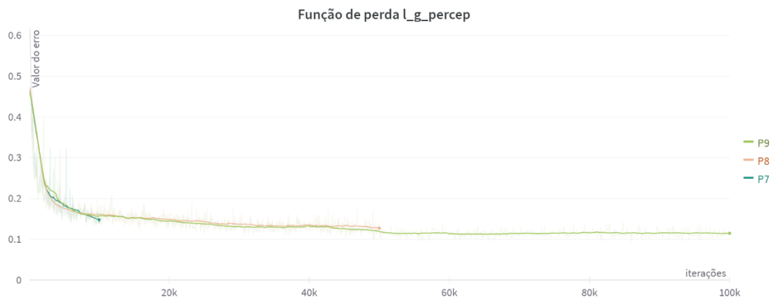
Figura 100 - Variação dos valores apresentados pelas funções de perda l_g_percep de cada um dos processamentos DEM-ESRGAN executados (P7, P8 e P9) em função da progressão das épocas dos mesmos (onde k equivale a 1.000)
