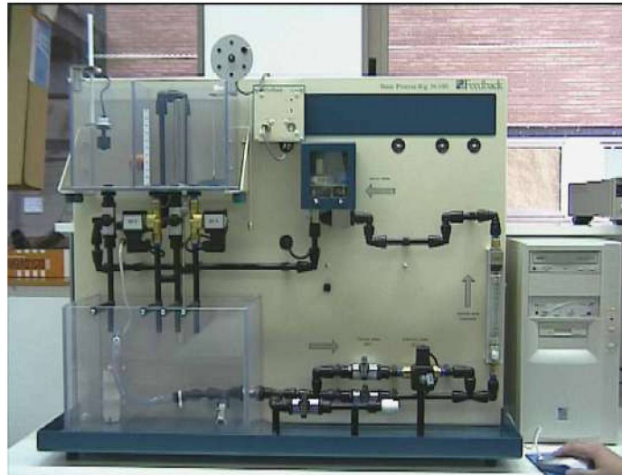
Figura 3.13: Foto do sistema de água corrente de baixa pressão projetado em bancada e totalmente independente. Fonte: (Monje et al., 2008).
