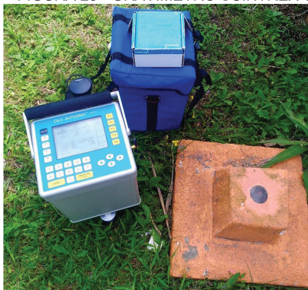
FIGURA 23 - GRAVÍMETRO SCINTREX CG-5.
