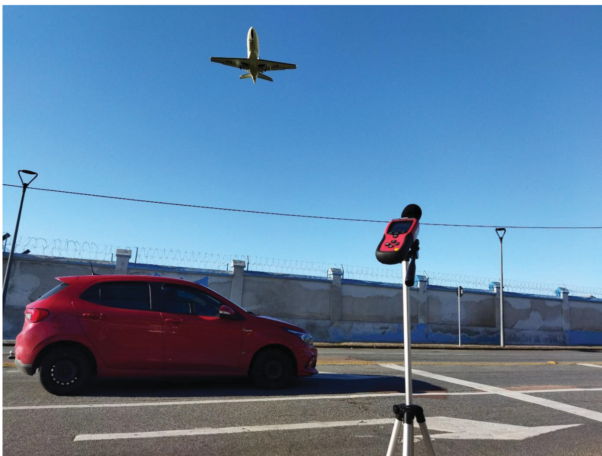
Figura 21 - Medição Próximo À Cabeceira - Ponto De Medição 3
