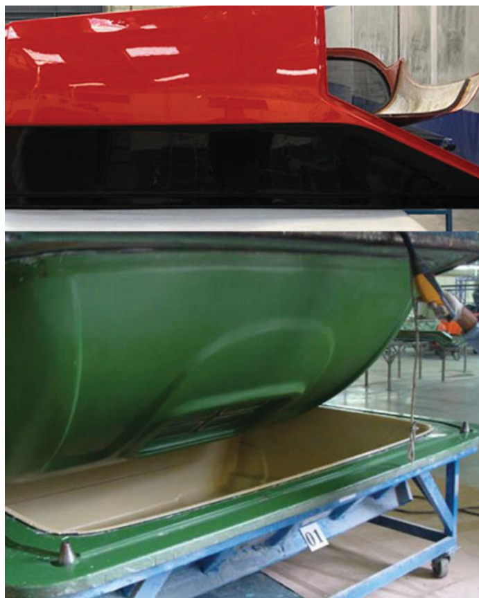
Figura 13 - Processo de fabricação por RTM Light.
