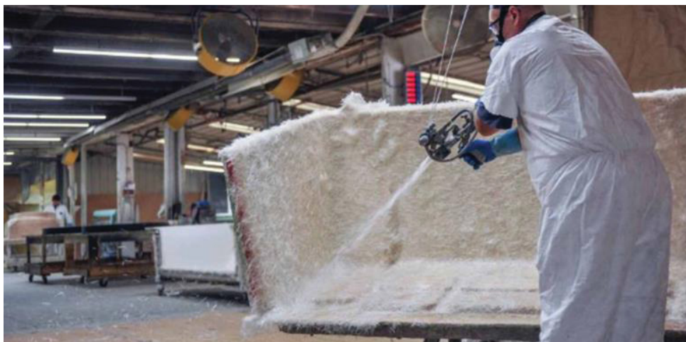
Figura 9 - Processo de fabricação RTM Skin.
