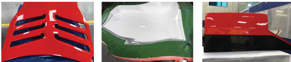
Figura 14 - Peças fabricadas pelo processo RTM Light.
