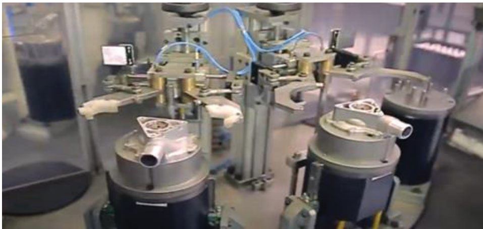
FIGURA 8 – ROBÔ PARA CÉLULAS DE MONTAGEM DE BOMBA D'ÁGUA.
