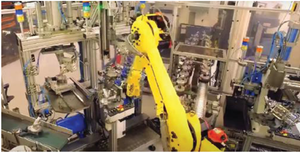
FIGURA 7 – ROBÔ PARA CÉLULAS DE MONTAGEM DE BOMBA D'ÁGUA.
