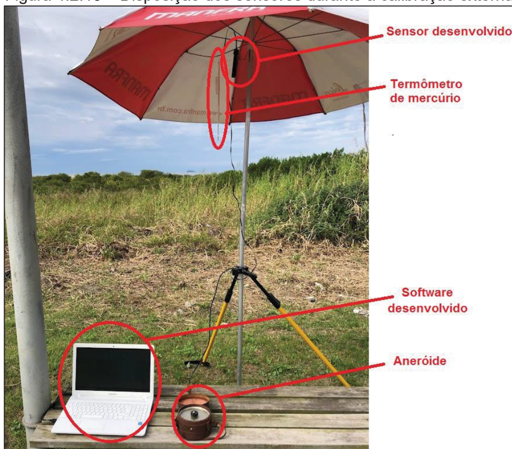
Figura 4.2.16 – Disposição dos sensores durante a calibração externa.
