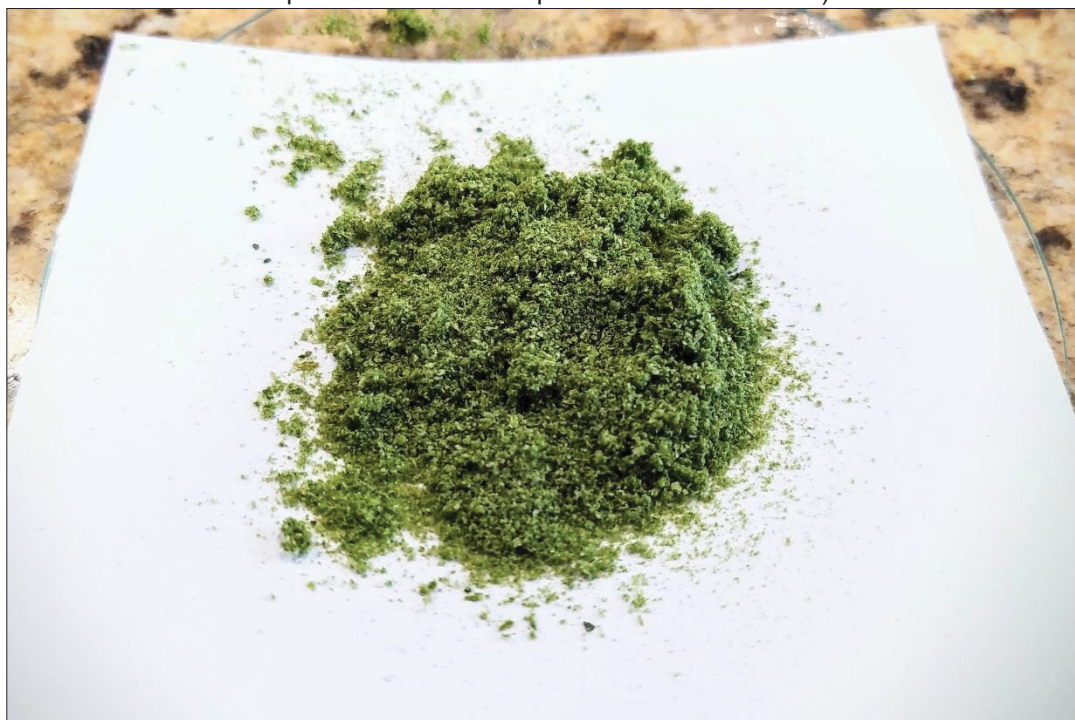
Figura 17: Folhas de Espinafre ( Spinacia oleracea ) após o processamento da amostra (tamanho de partícula da amostra processada de 20 mesh).
