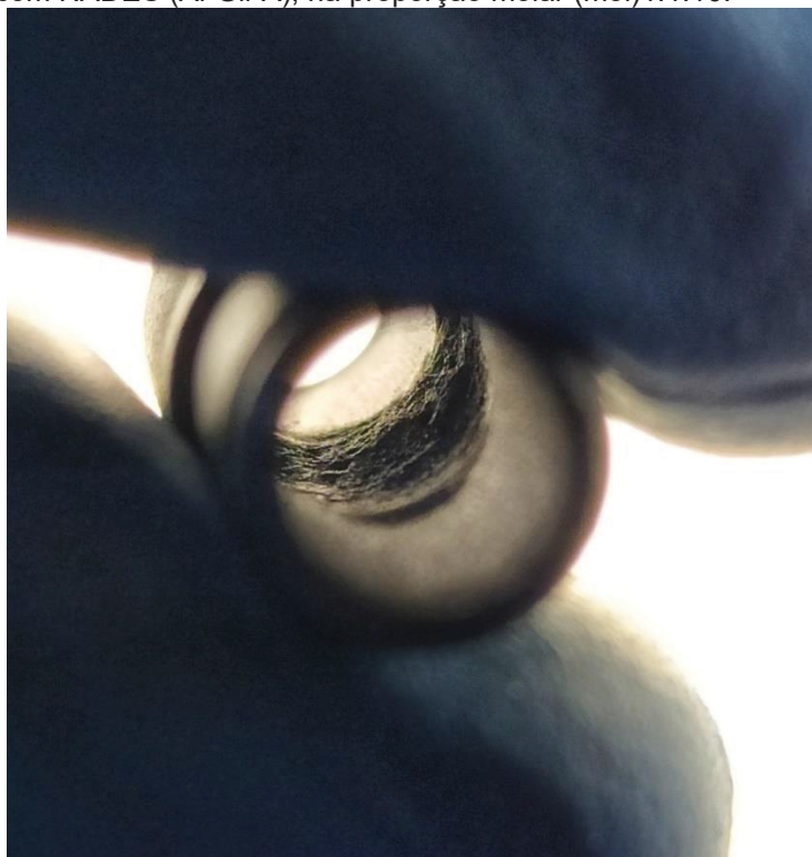
Figura 23: Forno -de grafite ap s sucessivas an lises (queimas), aproximadamente 500 queimas) com NADES (Al-Gli-A), na proporç o molar (mol)1:1:10.
