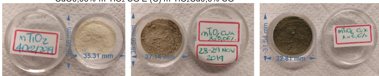
FIGURA 71 – FOTOGRAFIA DOS MATERIAIS SINTETIZADOS \text{CuO-m-TiO}_2 \text{SG} (A) m\text{-TiO}_2 \text{SG} (B), \text{CuO}0,06\%\text{-}m\text{-TiO}_2 \text{SG} E (C) m\text{-TiO}_2\text{Cu}0,6\% \text{SG}
