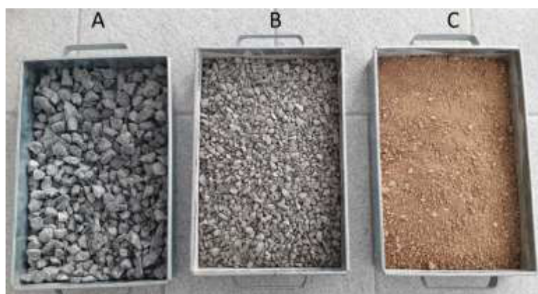
Figura 18 - Agregados: (A) brita 1, (B) brita 0, (C) areia
