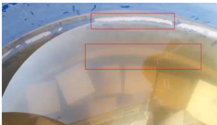
Figura 45 - Tanque de cura com sedimentação de cal
