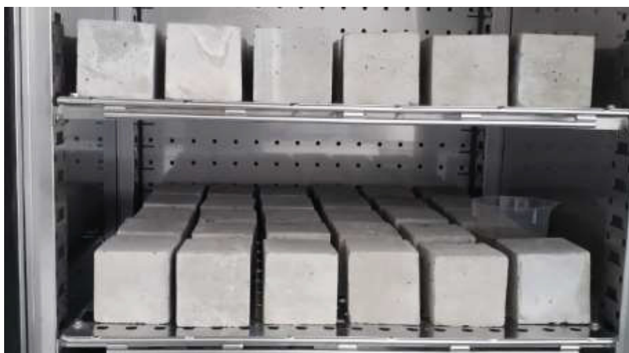
Figura 27 - Posicionamento dos CP's na câmara de carbonatação
