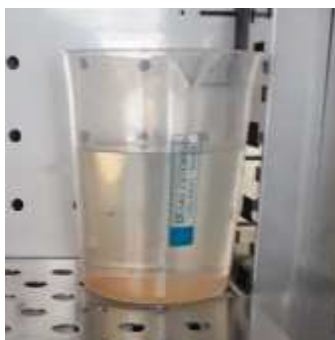
Figura 28 - Solução saturada de nitrito de sódio
