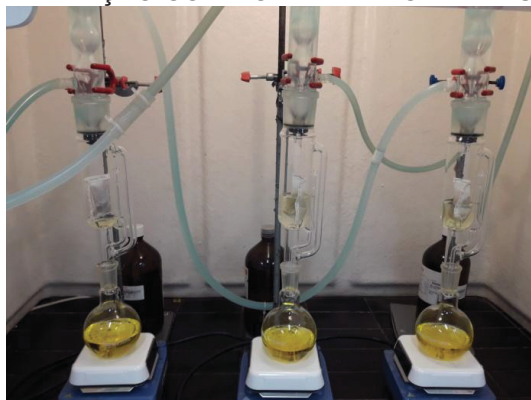
FIGURA 12 EXTRAÇÃO COM SOLVENTE POR REFLUXO DO RP1
