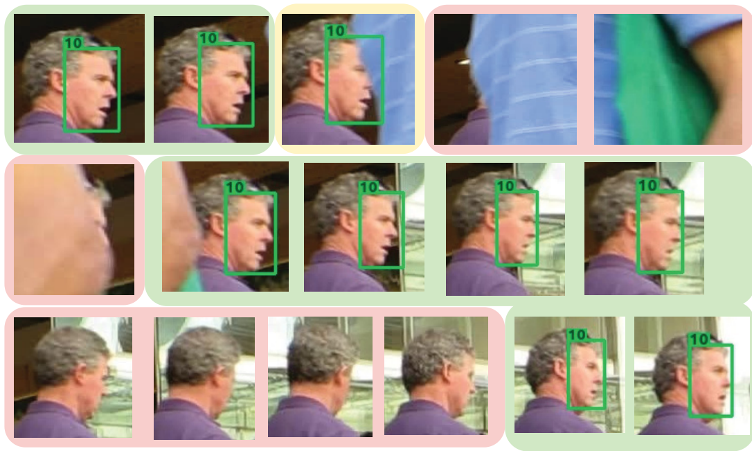
Figura 5.7: Demonstração de como as faces são anotadas ao longo de seu percurso, de forma que, apesar de oclusões totais e rotações extremas, a face volta a ser anotada com o mesmo identificador caso reapareça.
