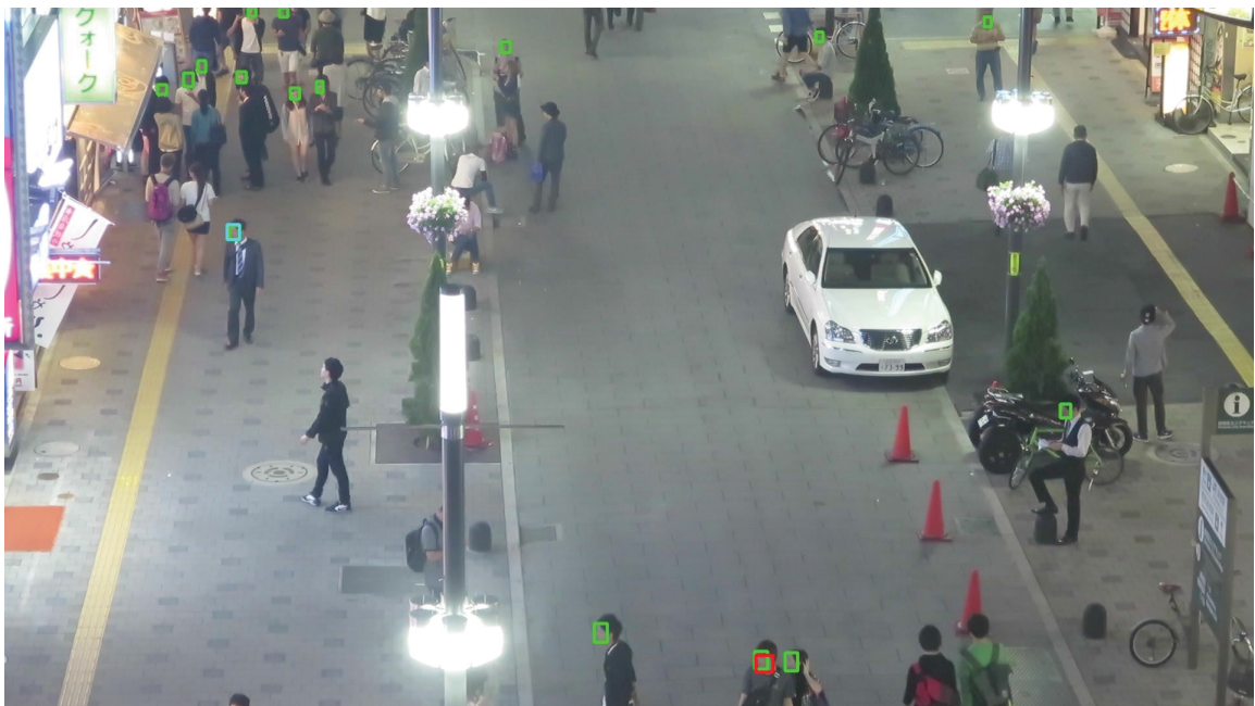
Figura 5.13: Quadro da sequência MOT17-04, anotado como parte do dataset suplementar proposto. Os retângulos em verde, vermelho e azul claro são referentes, respectivamente, ao groundtruth , baseline e experimento LTFT+Yolo5s+AQF.
