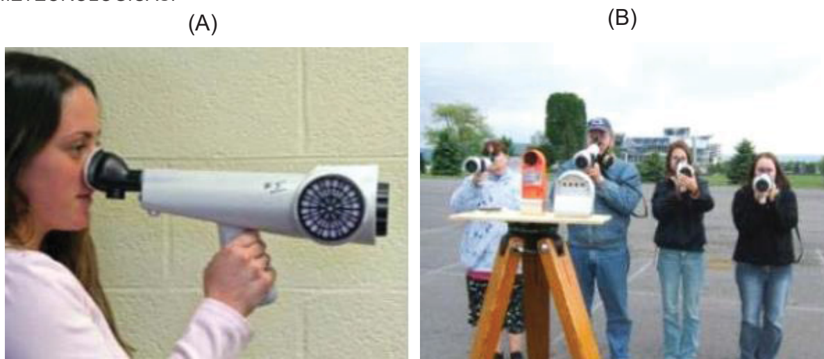
FIGURA 9 – (A) JURADA UTILIZANDO O OLFATÔMETRO DE CAMPO NASAL RANGER® E (B) PAINEL DE JURADOS USANDO O NASAL RANGER® , E TRIPÉ COM MEDIDORES DE VARIÁVEIS METEOROLÓGICAS.
