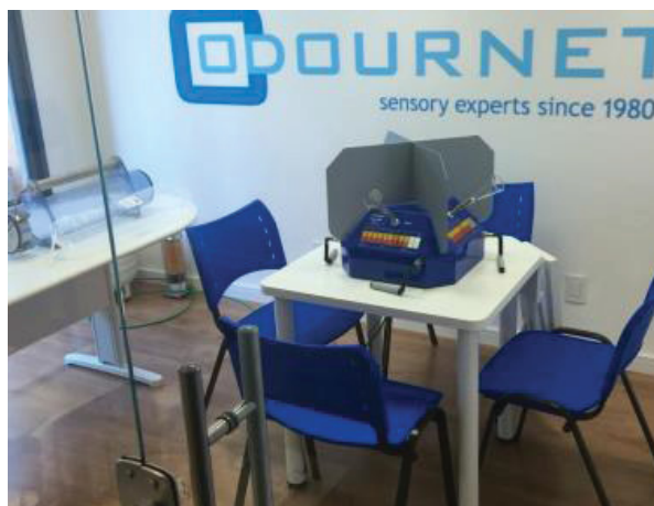
FIGURA 4 – OLFATOMETRIA DINÂMICA. (A) SALA DE ANÁLISE COM OLFATÔMETRO DE DILUIÇÃO DINÂMICA "PORTÁTIL" ODOURNET®; (B) JURADOS REALIZANDO A AVALIAÇÃO.
