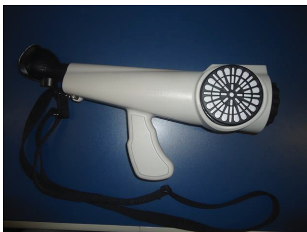
FIGURA 7 – OLFATÔMETRO DE CAMPO NASAL RANGER ® (A) VISTA LATERAL; (B) VISTA FRONTAL DO DISCO D/T, MOSTRANDO OS ORIFÍCIOS DE DIFERENTES TAMANHOS QUE PROPORCIONAM DIFERENTES TAXAS DE DILUIÇÃO (D/T).
