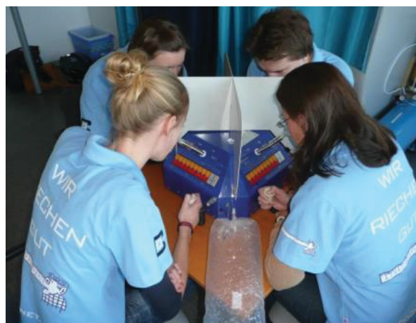
FIGURA 4 – OLFATOMETRIA DINÂMICA. (A) SALA DE ANÁLISE COM OLFATÔMETRO DE DILUIÇÃO DINÂMICA "PORTÁTIL" ODOURNET®; (B) JURADOS REALIZANDO A AVALIAÇÃO.
