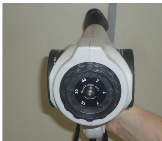
FIGURA 7 – OLFATÔMETRO DE CAMPO NASAL RANGER ® (A) VISTA LATERAL; (B) VISTA FRONTAL DO DISCO D/T, MOSTRANDO OS ORIFÍCIOS DE DIFERENTES TAMANHOS QUE PROPORCIONAM DIFERENTES TAXAS DE DILUIÇÃO (D/T).
