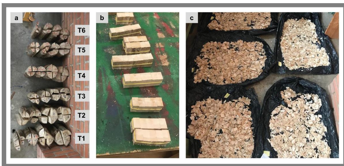
FIGURA 8 - TORETES DA REGIÃO DO DAP E MATERIAIS RETIRADOS PARA ENSAIOS
