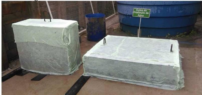
A moldagem dos corpos de prova foi feita em uma bancada com a superfície plana e regular (Figura 29) sendo que posteriormente os corpos de prova foram cobertos com filme plástico. A desforma dos corpos de prova foi realizada 48 horas após a concretagem, direcionando-se cada corpo de prova para sua respectiva cura (tanque normatizado, tanque ambiente e ao ar).
