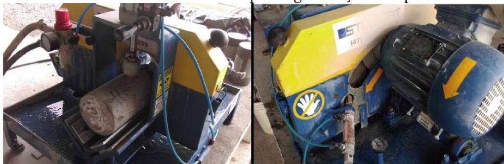
Após a regularização da superfície os corpos de prova cuja cura foi normatizada eram redirecionados para o tanque de cura, ao passo que os testemunhos e demais corpos de prova eram dispostos em ambiente de laboratório, até a data de rompimento, de 48 a 72 horas depois.
