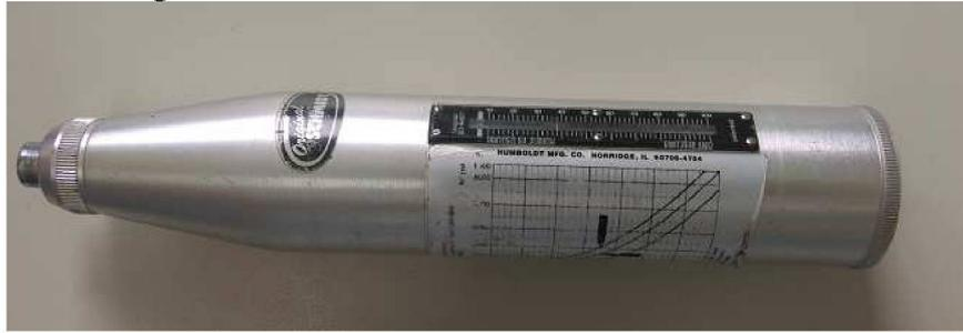
O ensaio se baseia no princípio da projeção de uma massa, através de uma mola, contra a superfície em análise. A função do aparelho é registrar a energia que sobra a partir da energia total empregada, ou seja, o recuo do martelo. Assim, em materiais com dureza superficial mais elevada, os recuos são maiores, enquanto que materiais com dureza superficial inferior, os recuos são menores.
