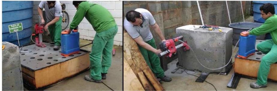
Foram tomadas precauções como o resfriamento da broca de extração com água, para que as extrações ocorressem de forma eficiente com menor chance de ocorrência de danos às amostras. Na Figura 32 é possível observar uma extração sendo realizada com o detalhe de dois blocos já extraídos ao fundo e outro bloco ainda em cura na parte inferior.
