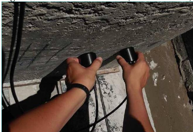
Figura 39 – Ensaio de ultrassom (método semi-direto).
