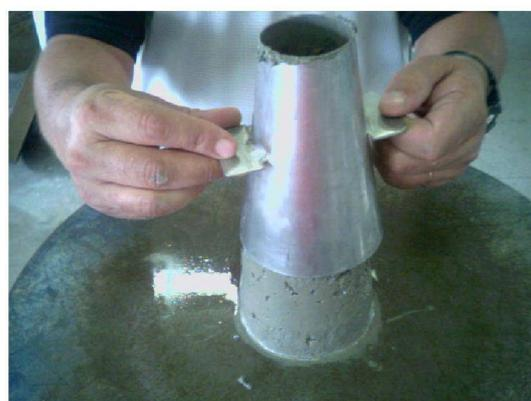
Levantar o mini-cone conforme a figura devagar.
