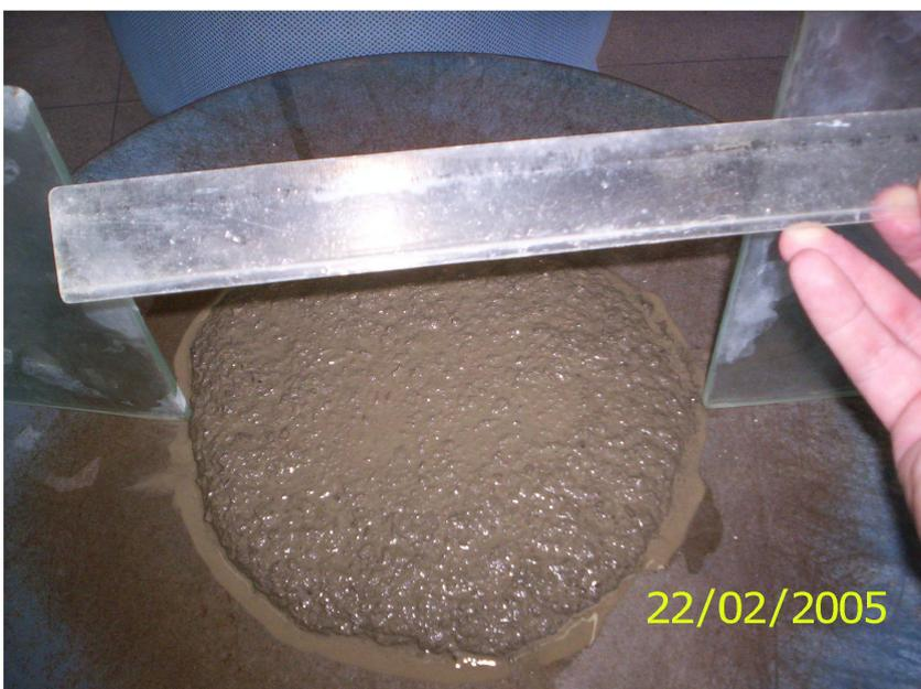
FIGURA 24 - Ensaio para Determinação do Índice de Consistência
