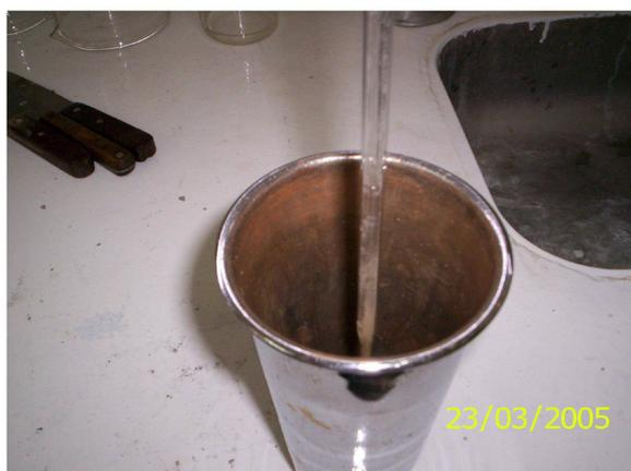
Retirar a água exsudada com pipeta em quatro coletas de 10 minutos e a cada 30 minutos consecutivos proceder a mesma operação, acondicionar material removido em recipiente que possa ser levado ao fogo, devido a nata de cimento que possa estar presente no material de coleta para posterior verificação da quantidade contida.
