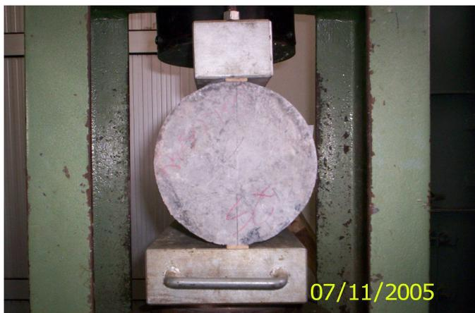
FIGURA 12 - Detalhe do ensaio de Tração por Compressão Diametral
