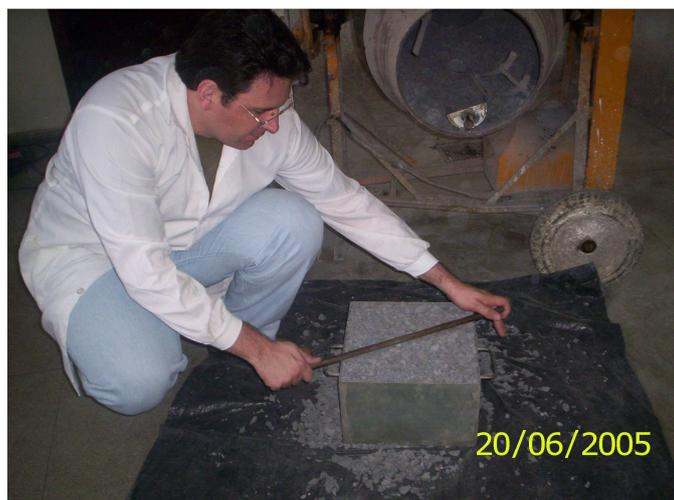
FIGURA 22 - Detalhe do ensaio de Massa Unitária Compacta Máxima
