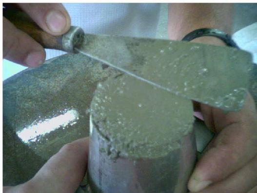
Após o término dos golpes nas respectivas camadas, com espátula alisar a superfície de argamassa conforme a figura acima. Em todo o momento do ensaio deve-se manter pelo menos uma mão segurando o recipiente para garantir que o mesmo não se desloque.
