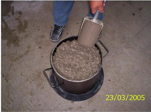
Lançar segunda camada e em seguida vibrar o concreto
