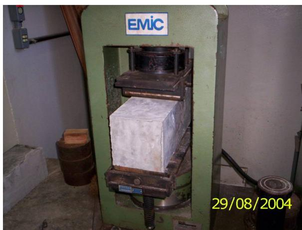
FIGURA 13 - Detalhe do ensaio de Tração por Flexão
