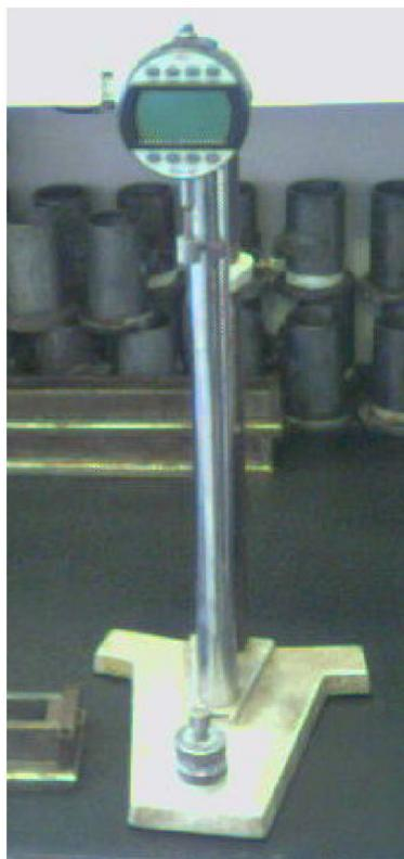
FIGURA 47 - Pórtico metálico com relógio comparador
