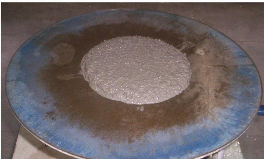
FIGURA 23 - Detalhe da Mesa de Consistência
