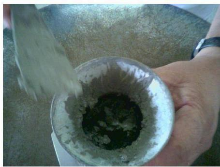
Inicialmente após o preparo da argamassa, em uma chapa de aço plana, posicionar o mini-cone conforme a figura acima, conectando a sua abertura superior funil ( o mesmo utilizado para encher moldes de argamassas com dimensões 5,0 x 10,0 cm), e iniciar o ensaio aplicando a primeira camada de argamassa até a terça parte do recipiente.
