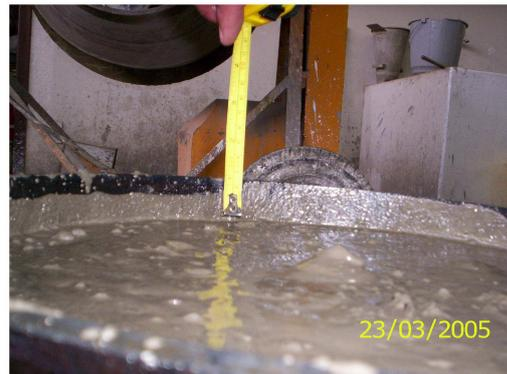
Após término da vibração, conferir a altura de 25mm da superfície do concreto até a borda do recipiente.
