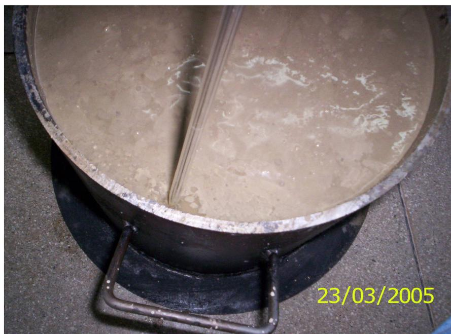
FIGURA 28 - Detalhe da retirada de água exsudada do concreto durante o ensaio de exsudação
