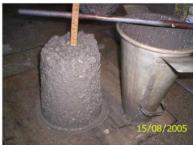
FIGURA 16 - Ensaio de abatimento do tronco de cone
