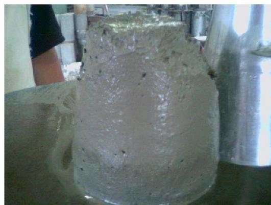
Virar o mini-cone, posicionar a haste de socamento conforme mostra a figura acima e medir a consistência da argamassa.
