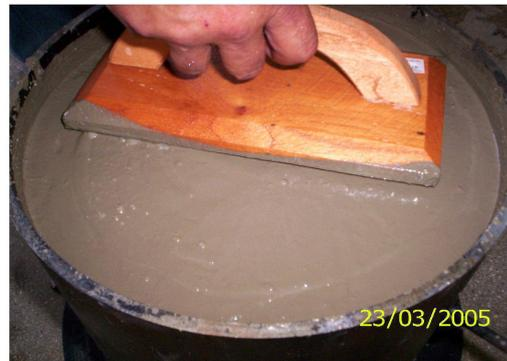
Com desempenadeira de madeira deve-se nivelar a superfície do concreto até que ela esteja plana, com um mínimo de alisamento
