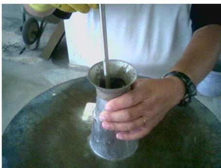
Aplicar 12 golpes com haste cilíndrica metálica de comprimento: 8,0 mm para cada uma das três camadas de argamassa.
