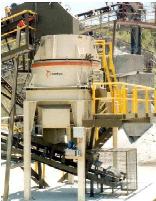
FIGURA 2 - Britador de Eixo Vertical VSI (METSO, 2006)
