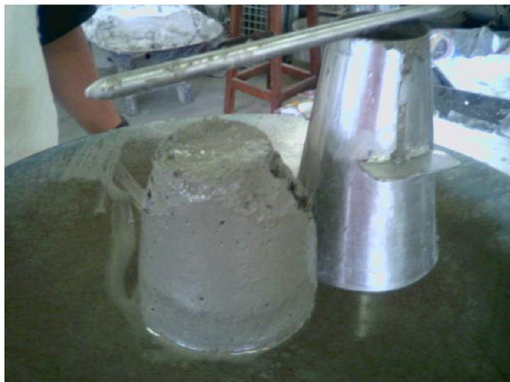
FIGURA 43 - Detalhe da medição do abatimento da argamassa
