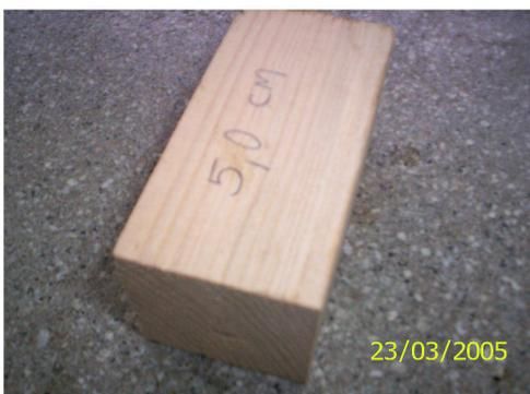
Para retirar a água exsudada do concreto, utilizar calço de 5,0 cm de um lado do recipiente para mantê-lo inclinado.
