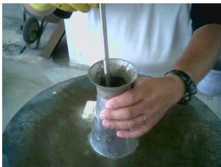
FIGURA 42 - Detalhe do adensamento da argamassa no tronco de cone
