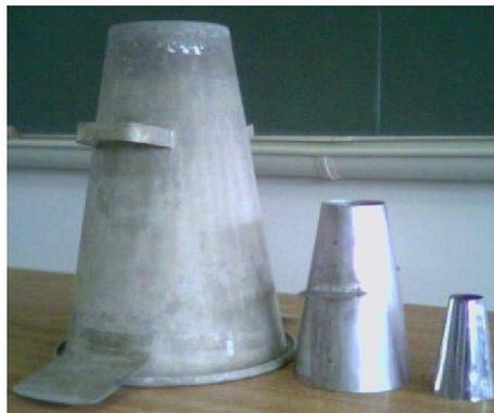
Nas figuras acima, é apresentado o mini-tronco de cone proposto por GORISSE (1981), este equipamento pode ser utilizado para o ensaio de consistência em argamassas, fazendo com que seja realizado a medida da consistência da mesma forma como se realiza nos concretos. O tronco de cone utilizado para este procedimento está nas figuras acima ao centro e possui as seguintes dimensões: altura: 15,0 cm; diâmetro inferior: 10,0 cm e diâmetro superior: 5,0 cm.
