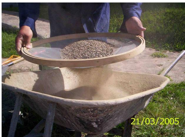
FIGURA 19 - Peneira com abertura média de malha 1,87 mm
