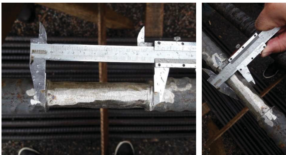
Figura 3.33 – Redução de seção das monobarras
