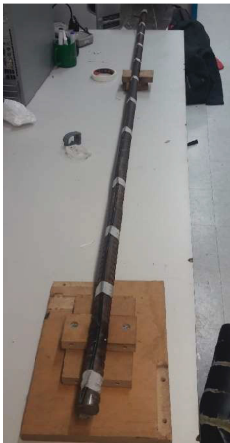
Figura 3.73 – Ensaio TDR realizado em grampo em contato com o ar
