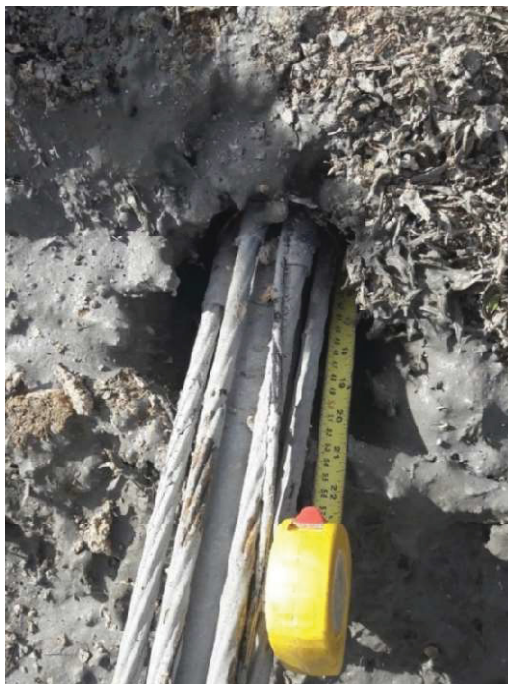
Figura 3.35 – Falha no início do furo com 50 cm de ar
