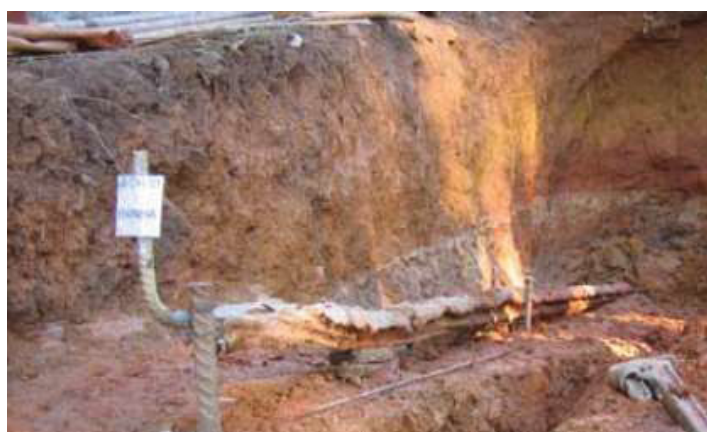
Figura 2.5 – Grampo executado somente com bainha
