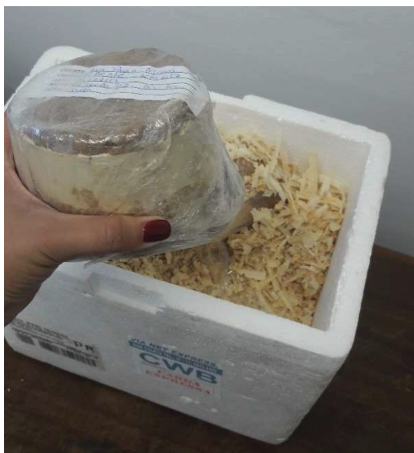
Figura 3.66 – Armazenamento das amostras indeformadas
