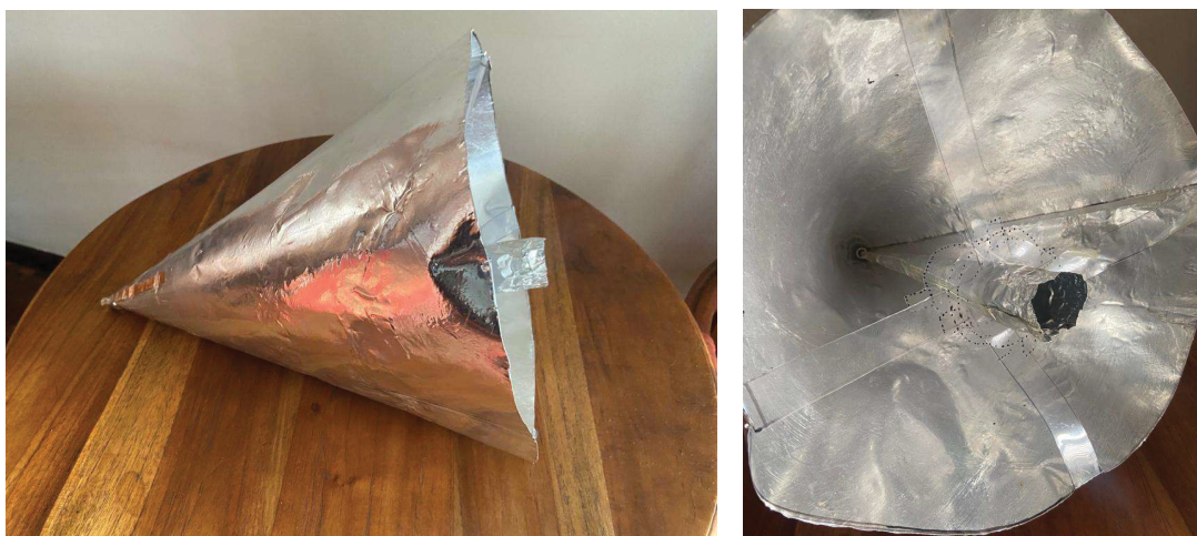
Figura 3.76 – Cone para realização do ensaio SW-TDR
