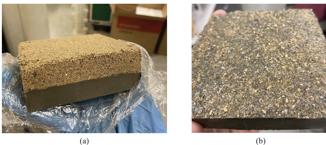
Legenda: (a) Amostra antes do ensaio; (b) Calda de cimento após o ensaio
