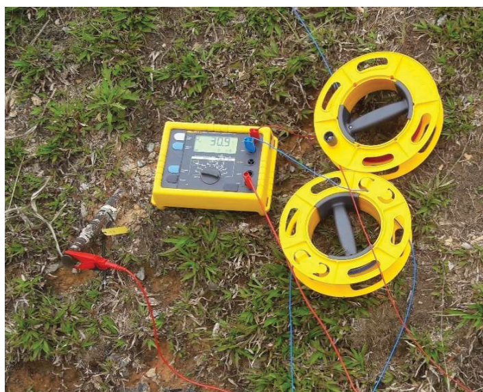
Figura 3.54 – Equipamento utilizado para medição de resistência elétrica das barras
