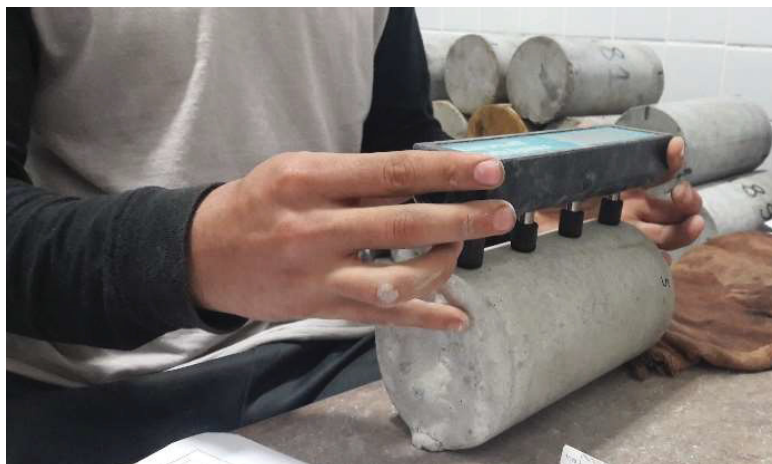
Figura 3.70 – Ensaio de resistividade elétrica
