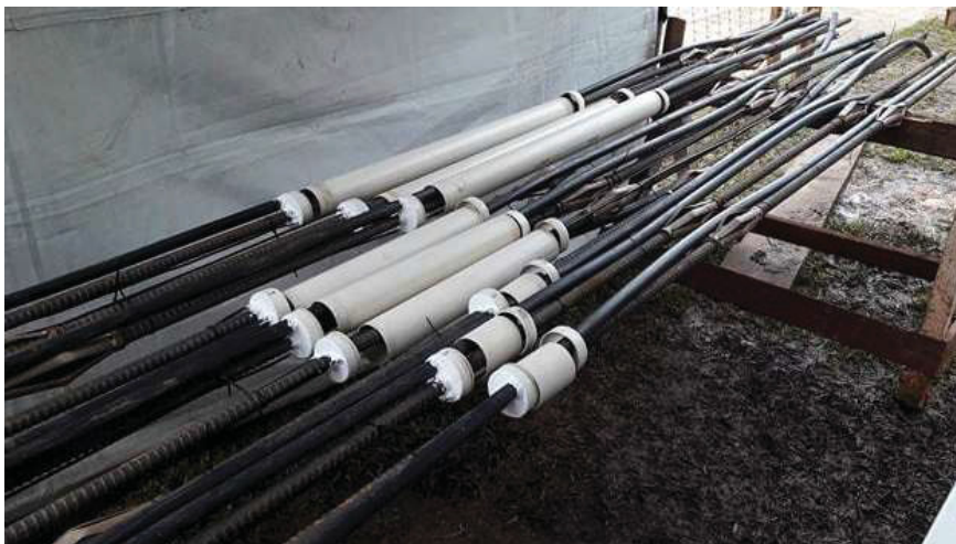
Figura 3.28 – Montagem das falhas com ar nos grampos
