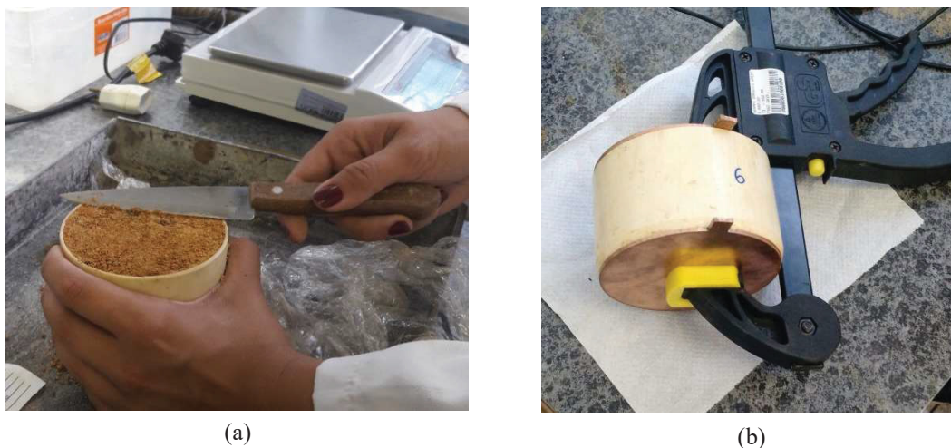
Legenda: (a) Regularização das faces; (b) Chapas de cobre
