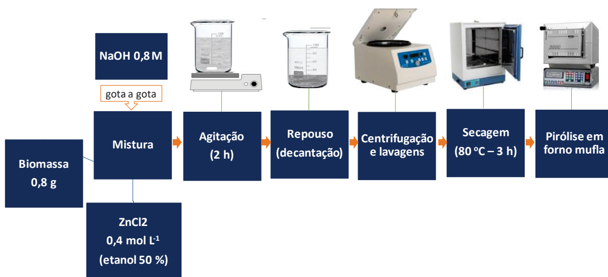
FIGURA 21 - FLUXOGRAMA DA SÍNTESE DAS AMOSTRAS DE ZnO/BIOCHAR.
