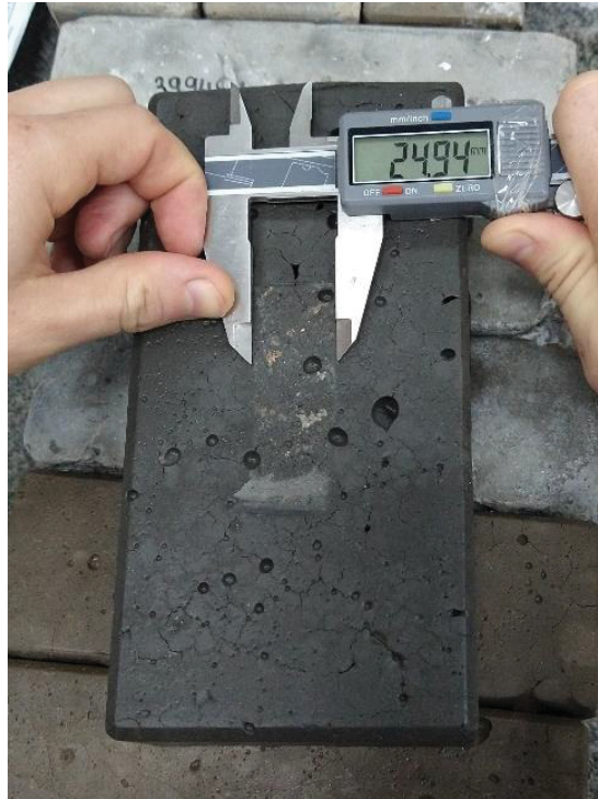
FIGURA 67: CORPO DE PROVA ABRASIONADO UTILIZADO NO ENSAIO DE ABRASÃO PROFUNDA
