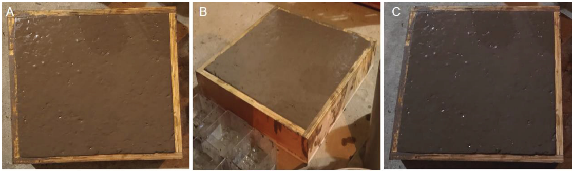
FIGURA 43: INEXISTÊNCIA DE EXSUDAÇÃO DE CP (a), GM (b) e GM10C (c)
