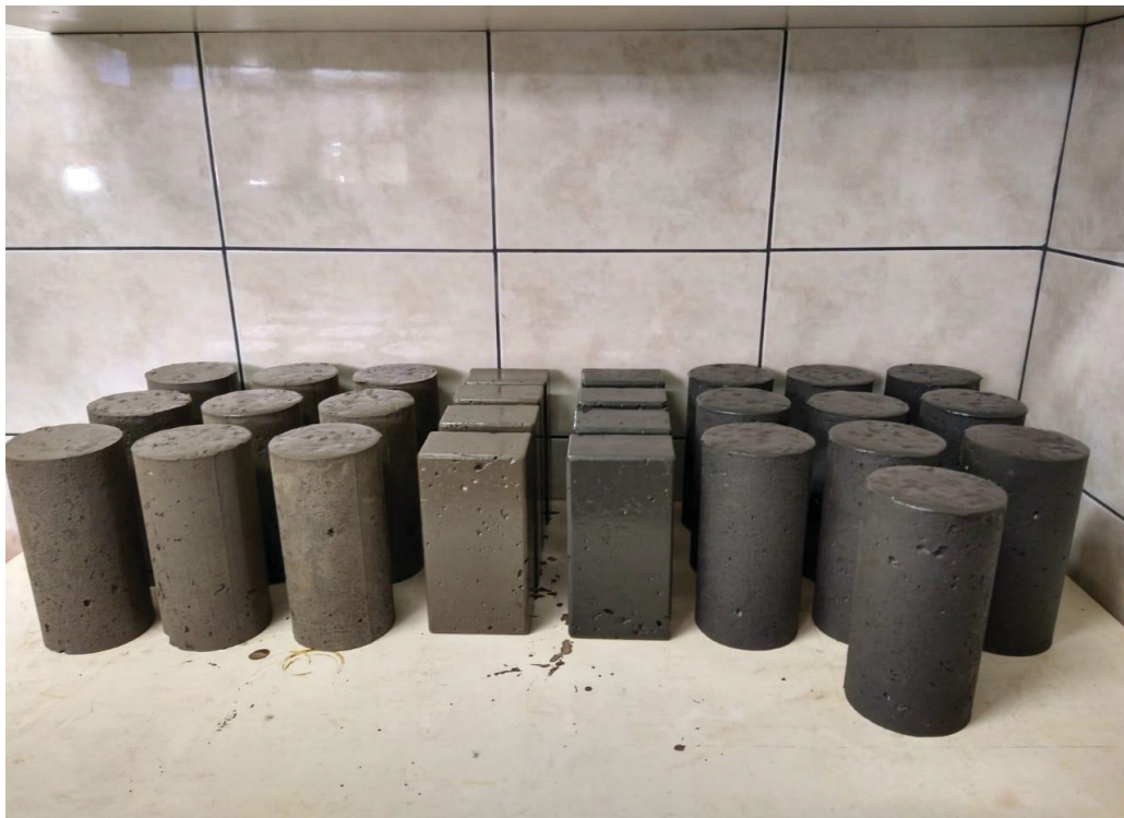
FIGURA 36: CURA AMBIENTE DE CORPOS DE PROVA GEOPOLIMÉRICOS
