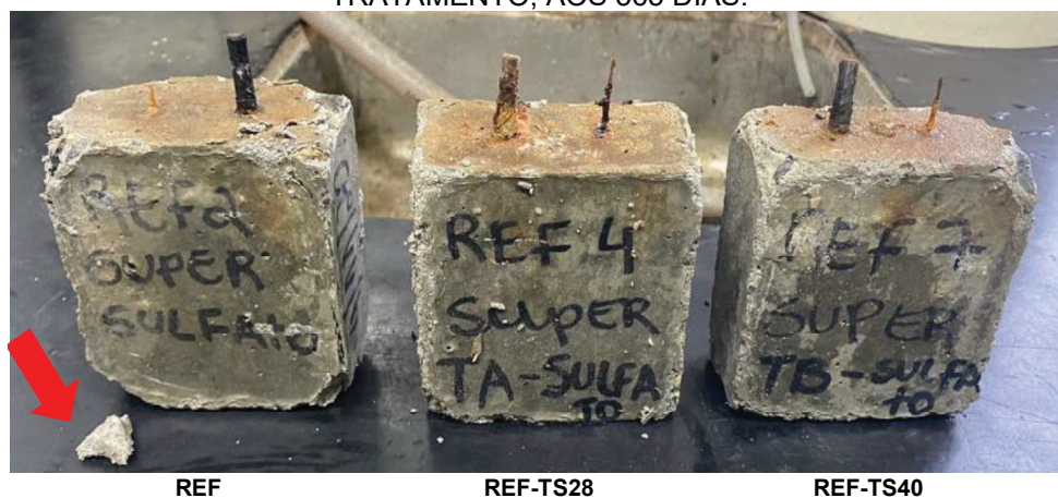
FIGURA 5.16 – SÉRIE REF EM SOLUÇÃO DE SULFATO DE AMÔNIO, COM E SEM TRATAMENTO, AOS 365 DIAS.
