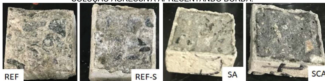
FIGURA 3.19 - AMOSTRA REFERÊNCIA E AMOSTRAS COM POZOLANAS IMERSAS EM SOLUÇÃO AGRESSIVA APRESENTANDO BORDA.
