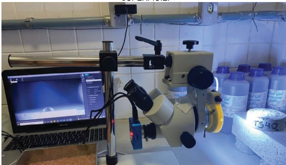
FIGURA 4.6 - MICROSCÓPIO ÓPTICO UTILIZADO PARA MEDIÇÃO DO ÂNGULO DE CONTATO DE UMA GOTA EM AMOSTRA DE CONCRETO COM E SEM TRATAMENTO DE SUPERFÍCIE.
