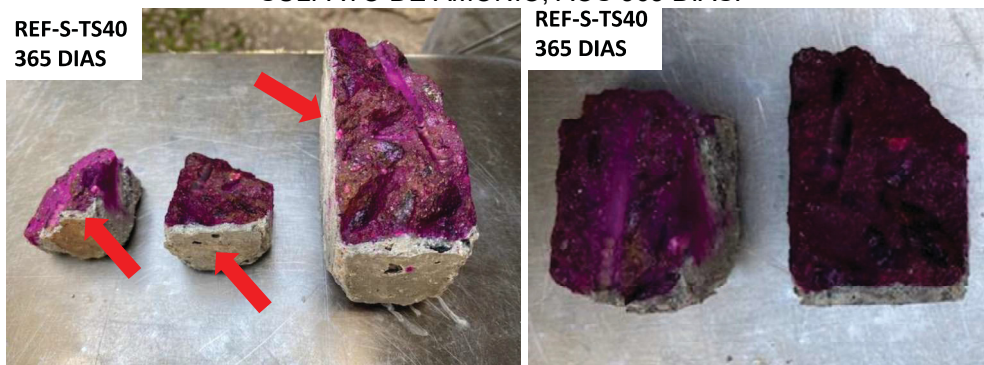
FIGURA 5.27 – MUDANÇA DE COR DA FENOLFTALEÍNA APLICADA À SEÇÃO TRANSVERSAL DO CORPO DE PROVA REF, COM TRATAMENTO TS40, EM SOLUÇÃO SULFATO DE AMÔNIO, AOS 365 DIAS.
