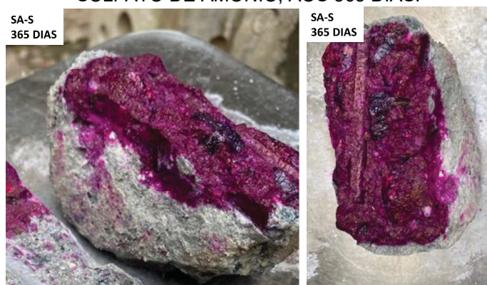
FIGURA 5.28 – MUDANÇA DE COR DA FENOLFTALEÍNA APLICADA À SEÇÃO TRANSVERSAL DO CORPO DE PROVA, SA, SEM TRATAMENTO, EM SOLUÇÃO DE SULFATO DE AMÔNIO, AOS 365 DIAS.
