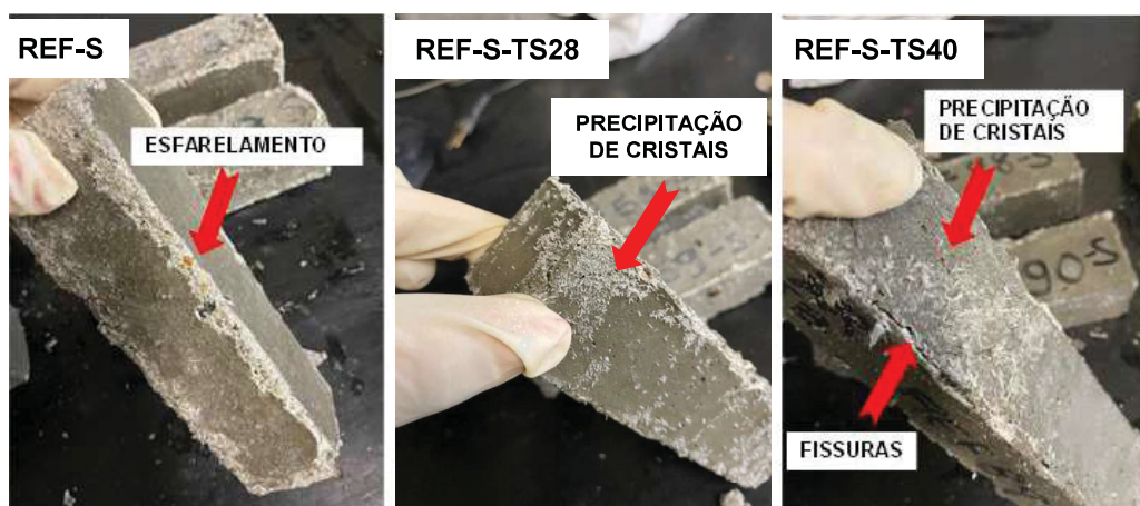
FIGURA 4.14 - DETALHE DAS AMOSTRAS EM SOLUÇÃO AGRESSIVA, AOS 365 DIAS, ANTES E APÓS O ENSAIO DE RESISTÊNCIA À TRAÇÃO NA FLEXÃO.
