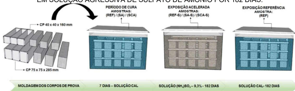
FIGURA 3.5 - DETALHE DA MOLDAGEM, CURA E EXPOSIÇÃO DAS AMOSTRAS IMERSAS EM SOLUÇÃO AGRESSIVA DE SULFATO DE AMÔNIO POR 182 DIAS.
