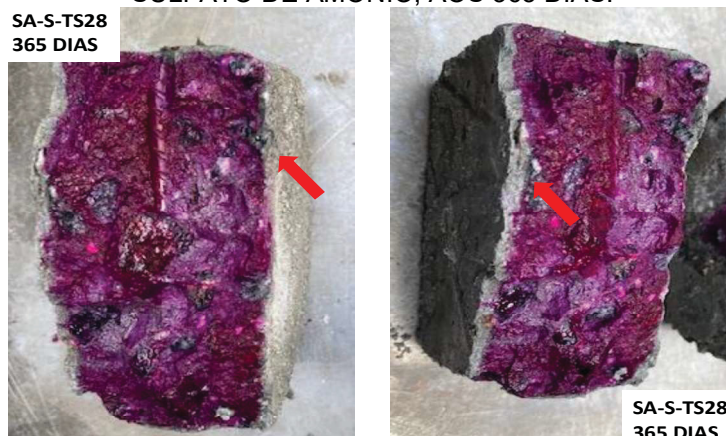
FIGURA 5.29 – MUDANÇA DE COR DA FENOLFTALEÍNA APLICADA À SEÇÃO TRANSVERSAL DO CORPO DE PROVA SA, COM TRATAMENTO TS28, EM SOLUÇÃO DE SULFATO DE AMÔNIO, AOS 365 DIAS.
