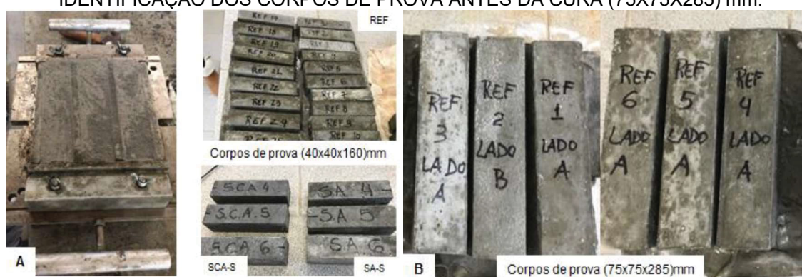
FIGURA 3.4 – (A) MOLDAGEM E DESFORMA DOS CP's (40X40X160) mm; (B) IDENTIFICAÇÃO DOS CORPOS DE PROVA ANTES DA CURA (75X75X285) mm.
