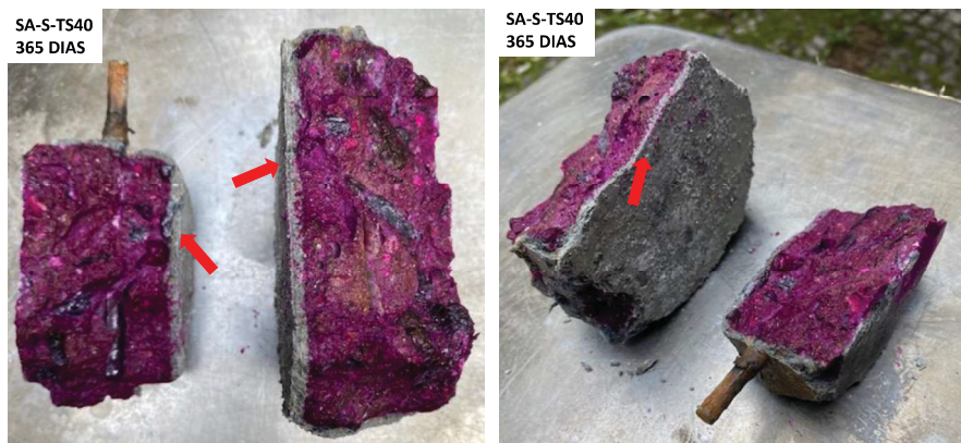
FIGURA 5.30 – MUDANÇA DE COR DA FENOLFTALEÍNA APLICADA À SEÇÃO TRANSVERSAL DO CORPO DE PROVA SA, COM TRATAMENTO TS40, EM SOLUÇÃO DE SULFATO DE AMÔNIO, AOS 365 DIAS.
