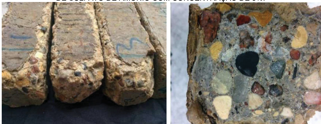
FIGURA 2.5 - AMOSTRAS DE CONCRETO APÓS 365 DIAS DE EXPOSIÇÃO EM SOLUÇÃO DE SULFATO DE AMÔNIO COM CONCENTRAÇÃO DE 5%.
