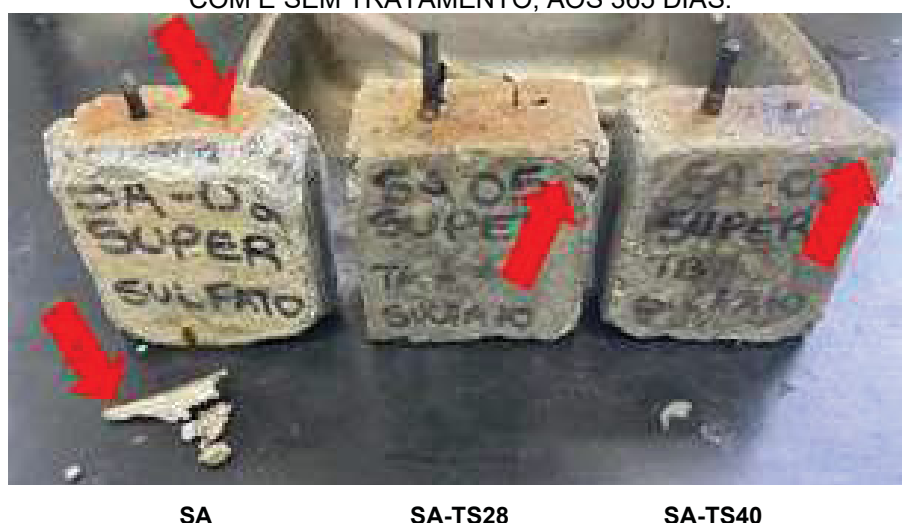
FIGURA 5.24 – SÉRIE COM SÍLICA ATIVA (SA), EM SOLUÇÃO DE SULFATO DE AMÔNIO, COM E SEM TRATAMENTO, AOS 365 DIAS.
