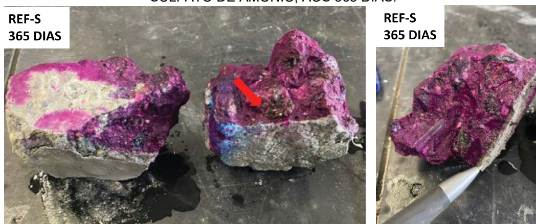
FIGURA 5.25 – MUDANÇA DE COR DA FENOLFTALEÍNA APLICADA À SEÇÃO TRANSVERSAL DO CORPO DE PROVA (REF), SEM TRATAMENTO, EM SOLUÇÃO DE SULFATO DE AMÔNIO, AOS 365 DIAS.
