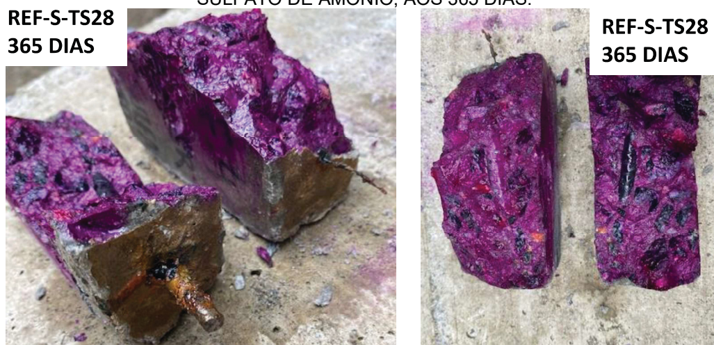
FIGURA 5.26 – MUDANÇA DE COR DA FENOLFTALEÍNA APLICADA À SEÇÃO TRANSVERSAL DO CORPO DE PROVA REF, COM TRATAMENTO TS28, EM SOLUÇÃO DE SULFATO DE AMÔNIO, AOS 365 DIAS.
