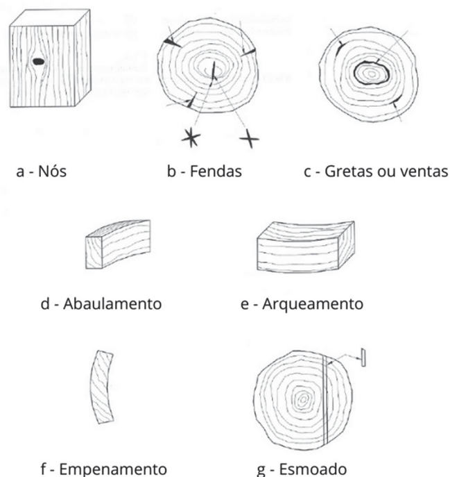
FIGURA 4 - DEFEITOS EVENTUAIS NA MADEIRA
