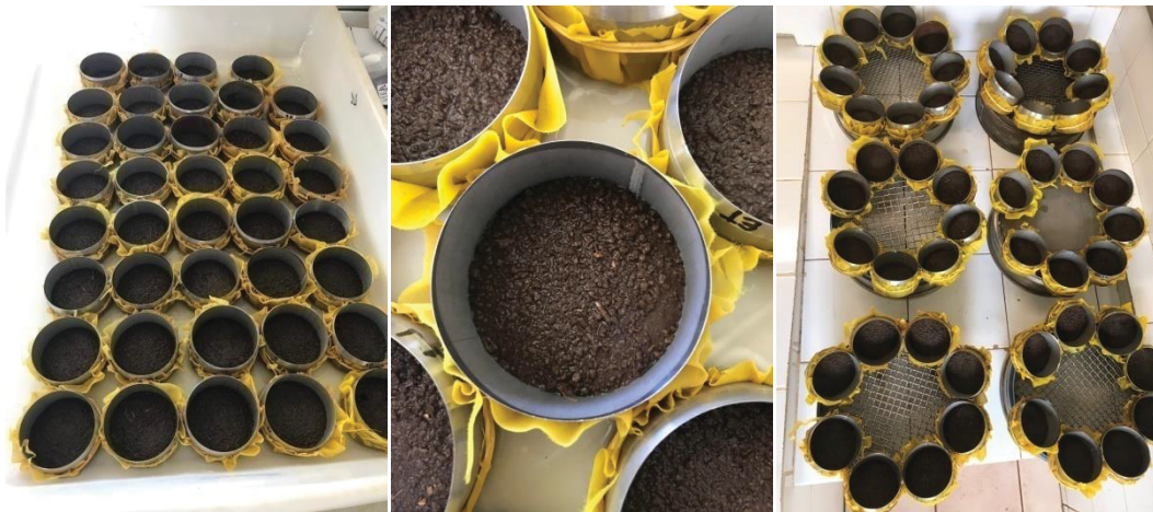
Figura 3. Amostras de solos umedecidas até a capacidade de campo e colocadas para drenar.
