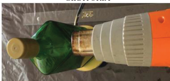
FIGURA 18 – FOTO DO PROCESSO DE AQUECIMENTO COM SOPRADOR TÉRMICO POSICIONADO A, APROXIMADAMENTE, 7 CM DA AMOSTRA APOIADA SOBRE GARRAFA EM CIMA DE BASE GIRATÓRIA
