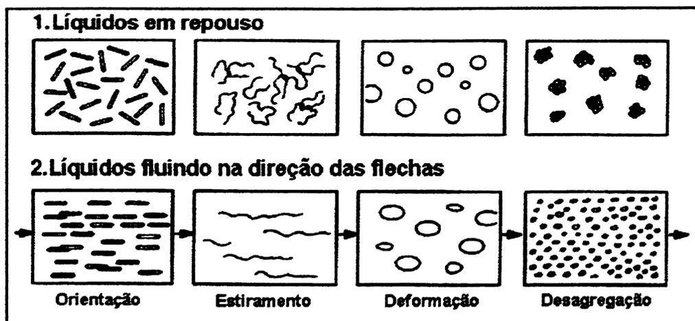
Figura 4: Comportamento de moléculas em repouso (1) e sob cisalhamento (2) (adaptado de Schramm, 1994).
