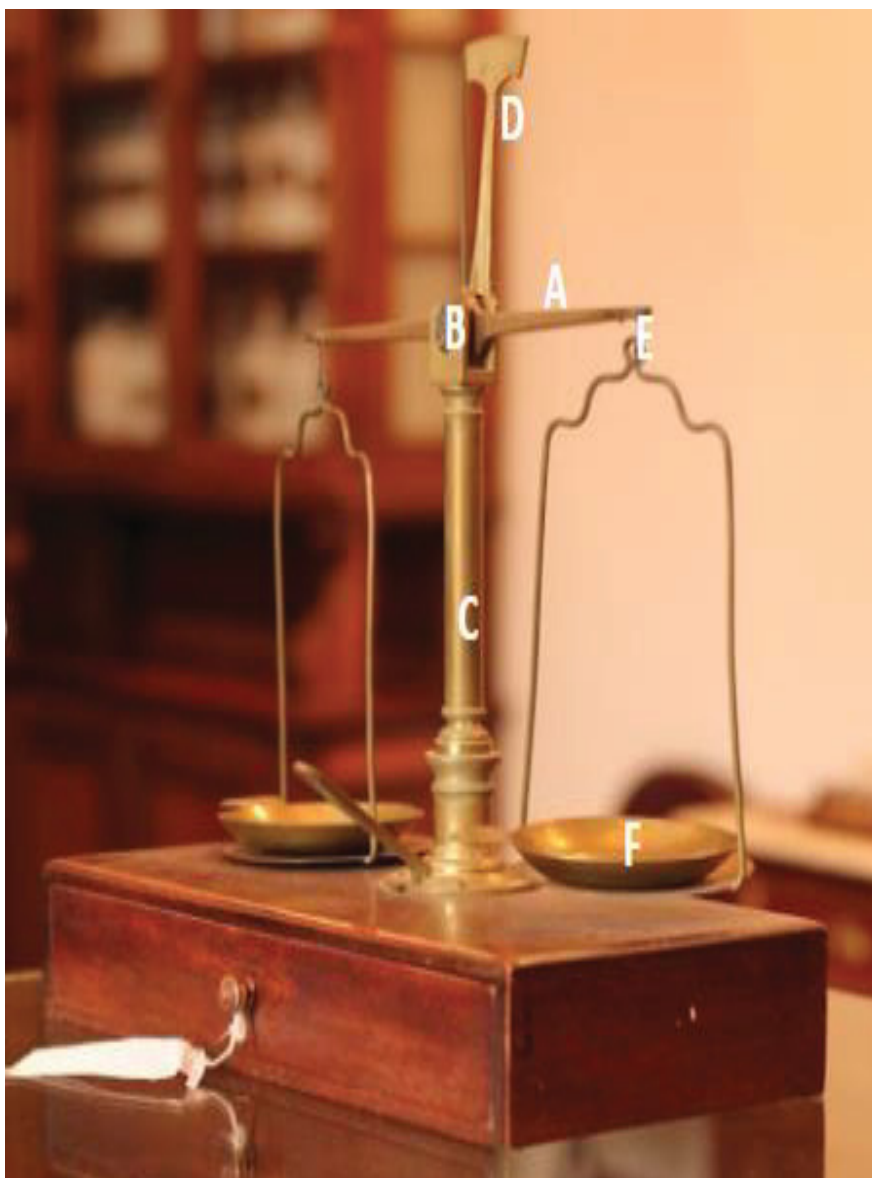
FIGURA 26: COMPONENTES DA BALANÇA
