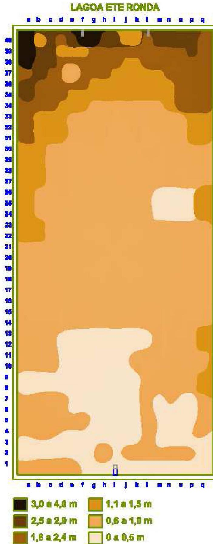
Figura 19 – Mapeamento da altura da camada de lodo na lagoa da ETE Olarias.
