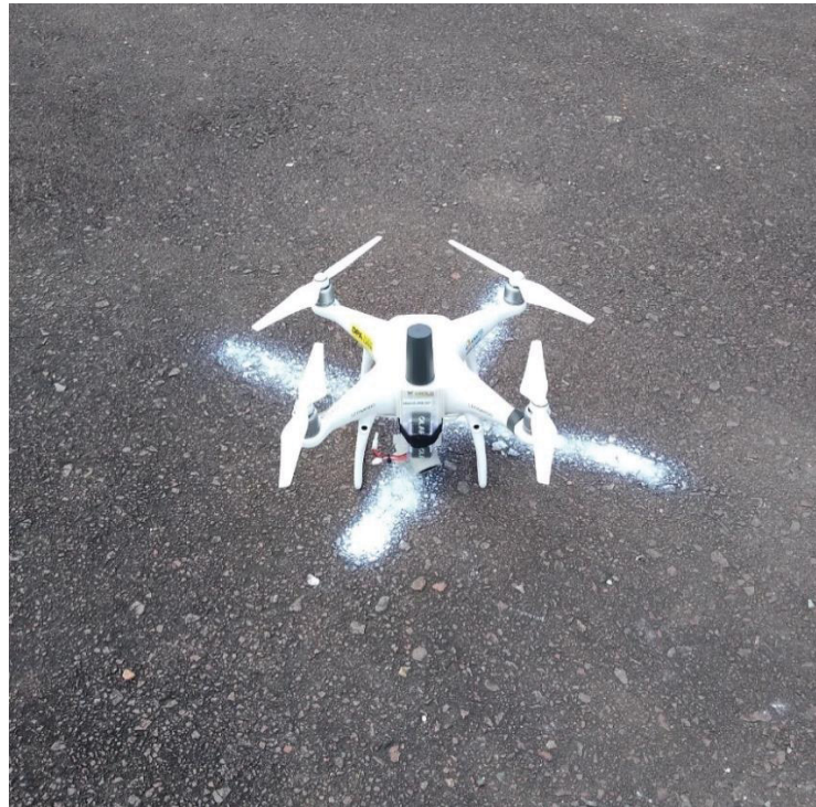
FIGURA 8 – PHANTOM 4 ADVANCED DA DJI, COM O KIT PPK2 DA GUANDALINI ACOPLADO
