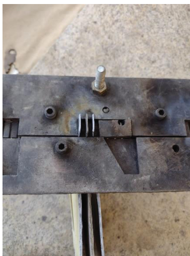
FIGURA 35 - PENTE COM AS PLACAS ANTES DA SOLDA
