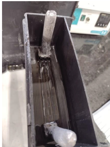
FIGURA 37 - PLACAS ALOCADAS NO VASO PARA TESTES
