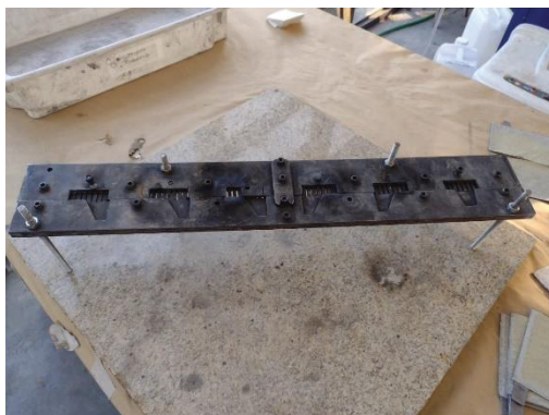
FIGURA 33 - PENTE PARA SOLDA DAS PLACAS
