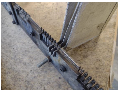
FIGURA 34 - PENTE COM AS PLACAS ALOCADAS PARA SOLDA
