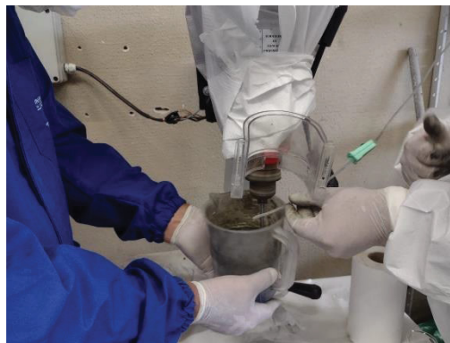
FIGURA 53 - PREPARO DA MASSA PARA EMPASTE DAS PLACAS
