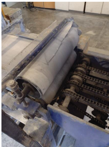
FIGURA 26 - ROLO PARA COMPRESSÃO DAS PLACAS APÓS EMPASTE
