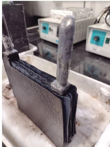
FIGURA 36 - SOLDA DAS PLACAS POSITIVAS E NEGATIVAS
