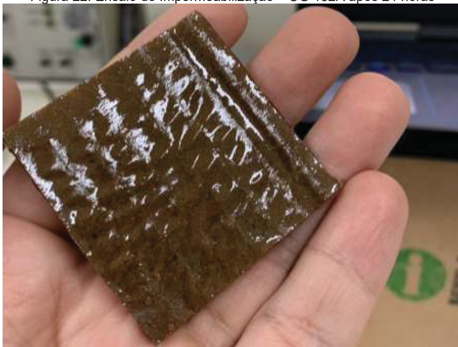
Figura 22: Ensaio de Impermeabilização – UG 132A após 24 horas
