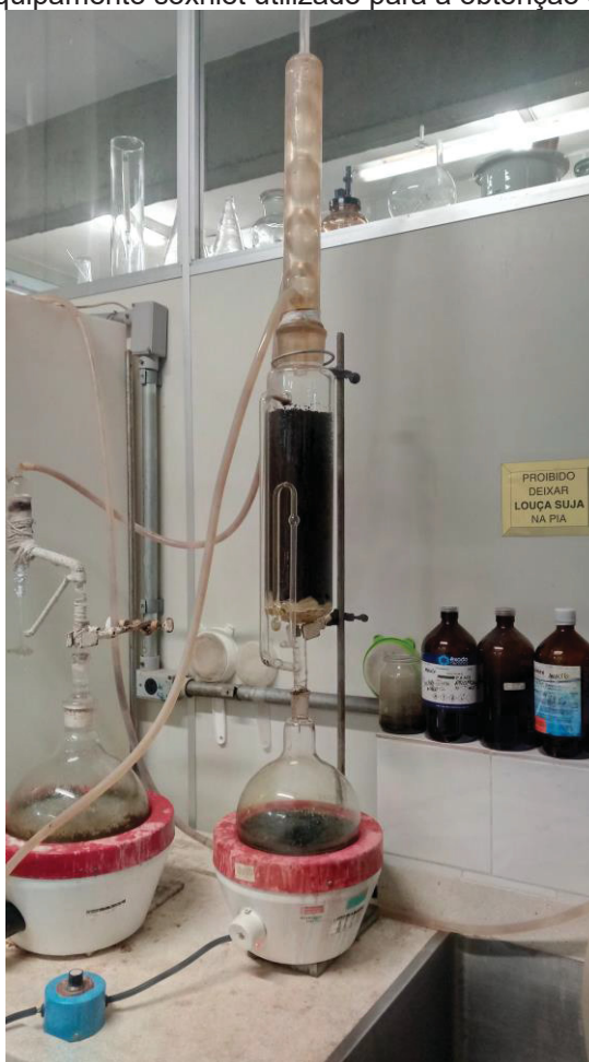
FIGURA 6 - Equipamento soxhlet utilizado para a obtenção do extrato bruto
