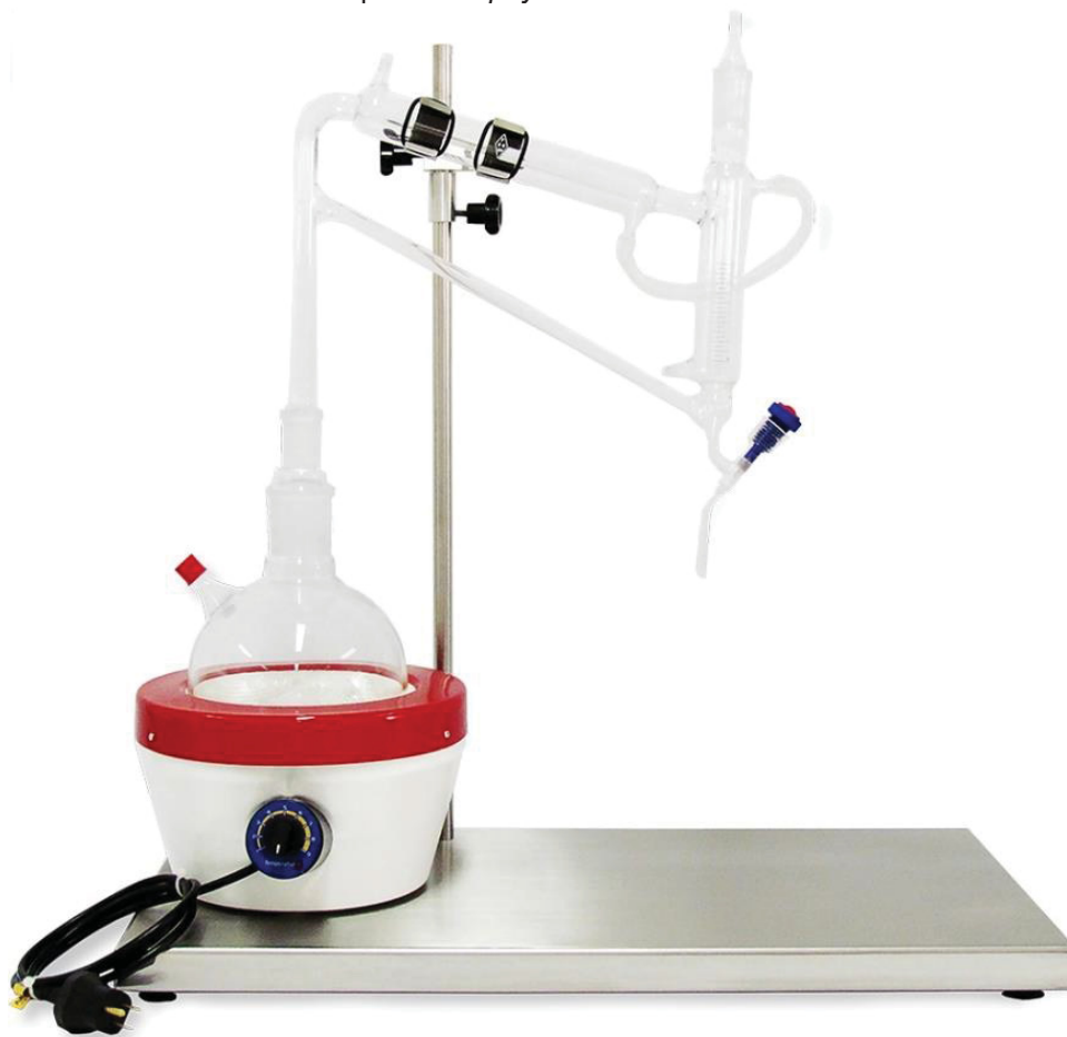
FIGURA 5 - Equipamento de Clevenger usado para a extração do óleo essencial das folhas da espécie Allophylus semidentatus
