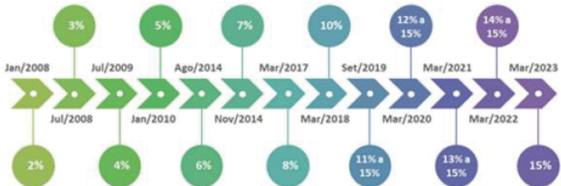
FIGURA 3 - LINHA DO TEMPO DOS PERCENTUAIS DE ADIÇÃO DO BODIESEL PARA FORMULAÇÃO DO DIESEL B
