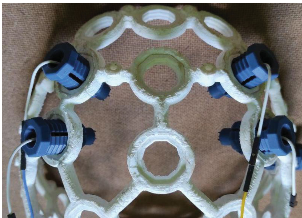
Figura A.23: Montagem: encaixando os quatro eletrodos, F3, F4, AF3 e AF4, de acordo com o sistema 10-20, necessários para o FEA.
