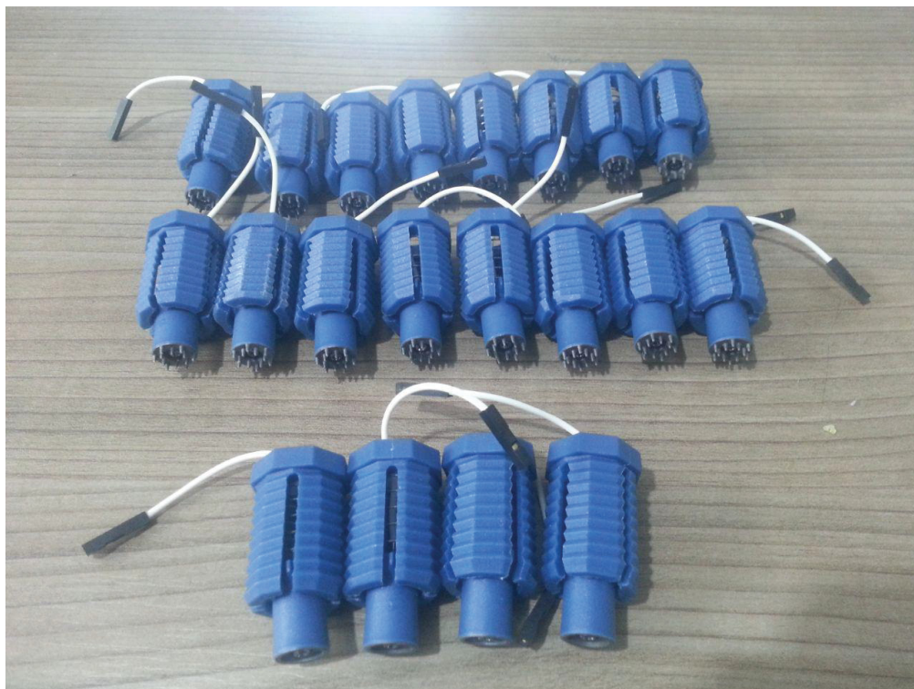
Figura A.16: Eletrodos secos de cloreto de prata. Fonte: Própria.
