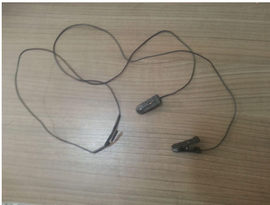
Figura A.18: Eletrodos em forma de pinça para fixação no lobo auricular, A1 e A2 no sistema 10-20, servindo como terra.
