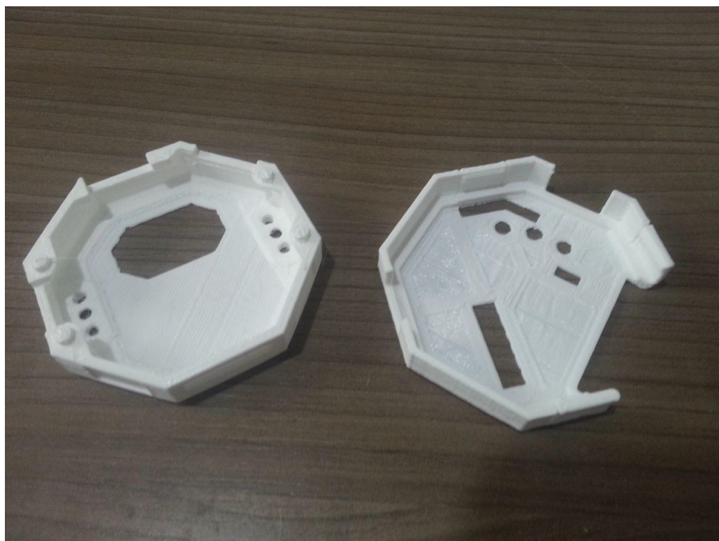
Figura A.5: Peças impressas: Estrutura que segura a placa eletrônica. Fonte: Própria.
