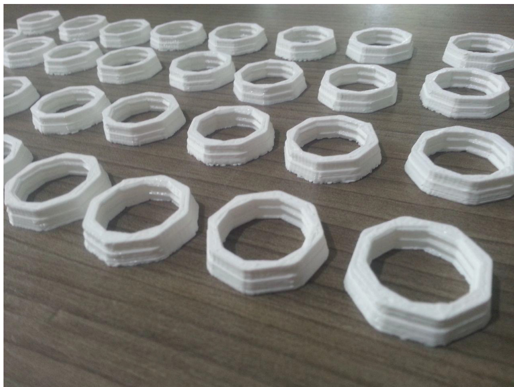
Figura A.6: Peças impressas: Polcas que seguram os eletrodos. Fonte: Própria.
