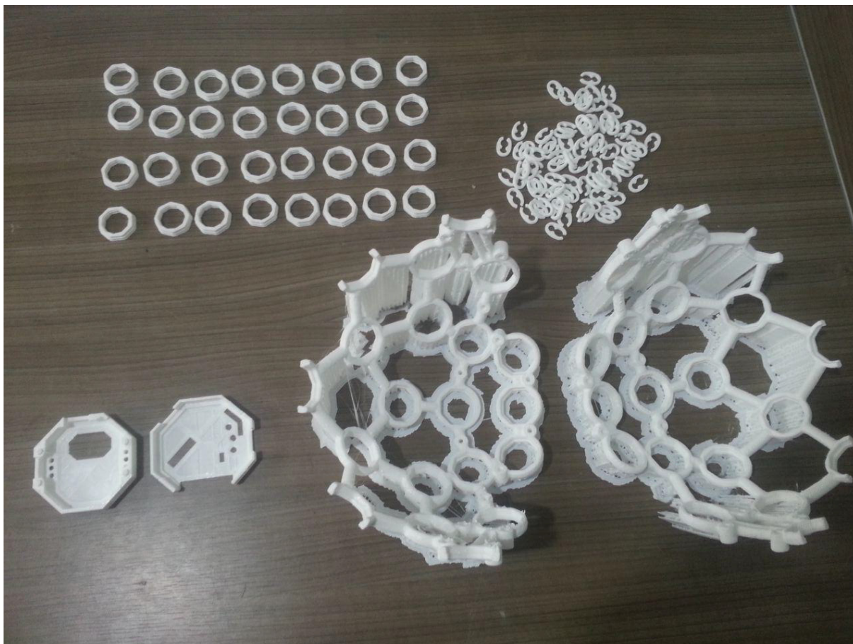
Figura A.4: Objetos impressos de acordo com os arquivos STL do OpenBCI
