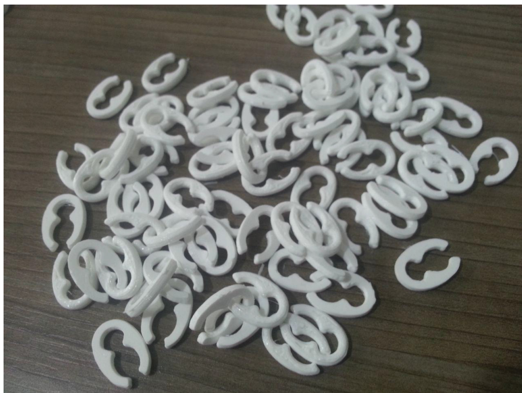
Figura A.7: Peças impressas: Clipes para segurar jumpers . Fonte: Própria.
