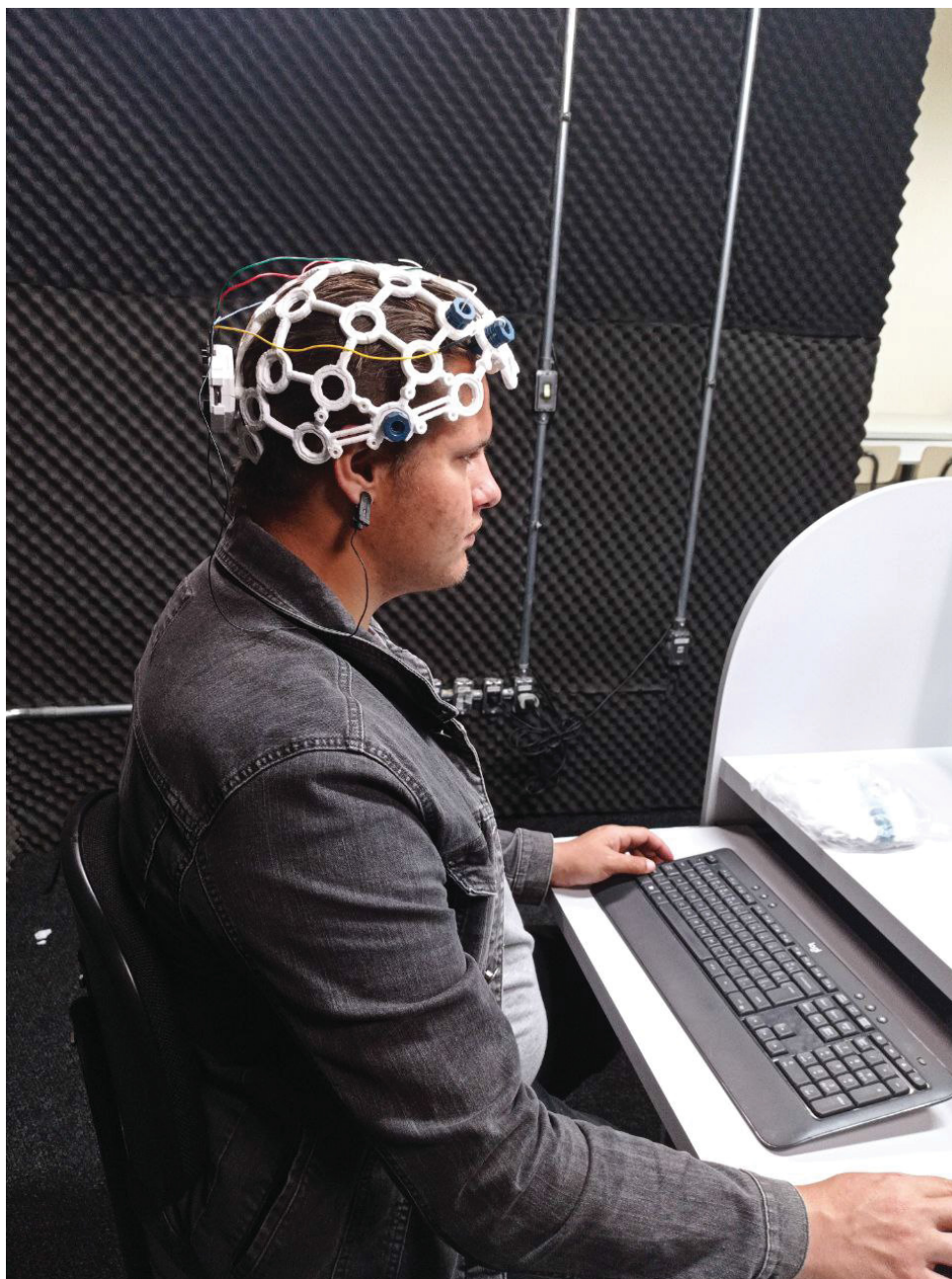
Figura A.33: Utilização OpenBCI: Visão lateral direita do estudante com OpenBCI. Fonte: Própria.
