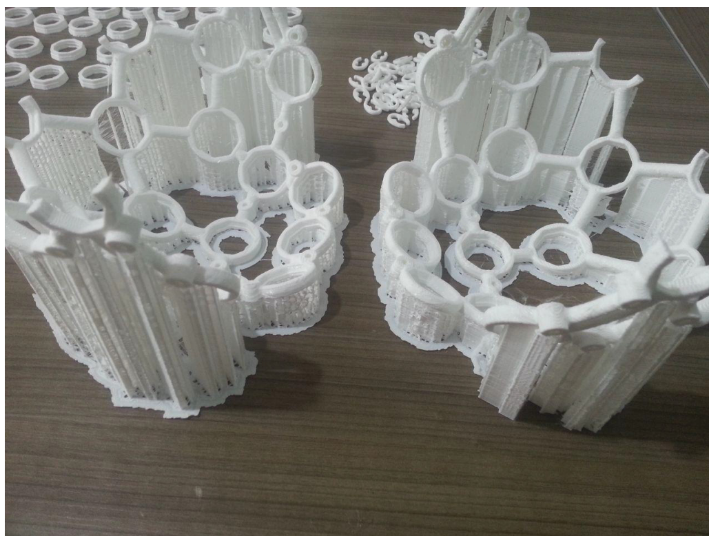
Figura A.8: Peças impressas: Frames dividida em duas partes. Fonte: Própria.
