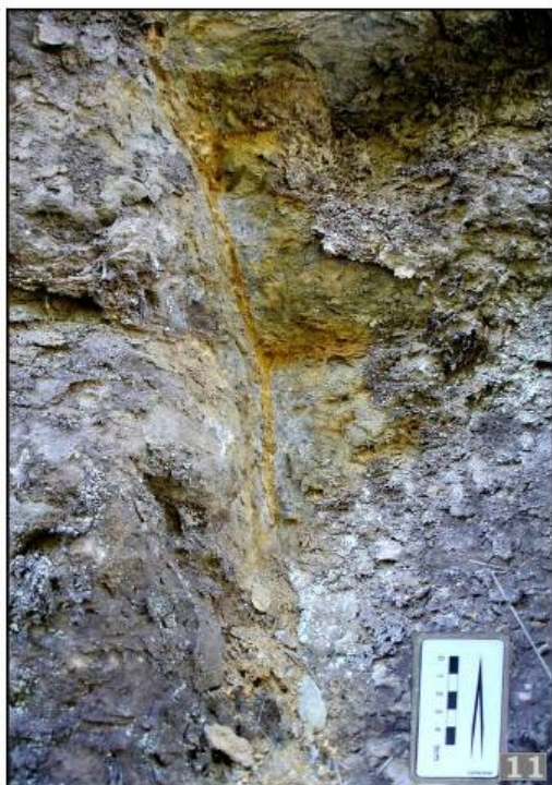
Foto 11: Detalhe da falha observada no talude do trecho 1, de atitude N50E/71SE; Foto 12: Imagem do siltito no talude SE – montante, onde se verifica escoamento superficial constante de água.
