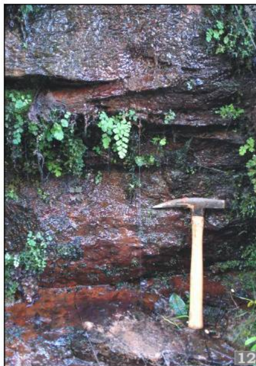
Foto 11: Detalhe da falha observada no talude do trecho 1, de atitude N50E/71SE; Foto 12: Imagem do siltito no talude SE – montante, onde se verifica escoamento superficial constante de água.
