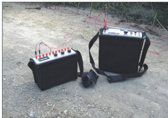
Foto 8: Equipamentos utilizados para a coleta de resistividade aparente: à esquerda o aparelho receptor VR250 que mede a resistividade aparente, à direita o aparelho transmissor VT250 que injeta corrente alternada no substrato.
