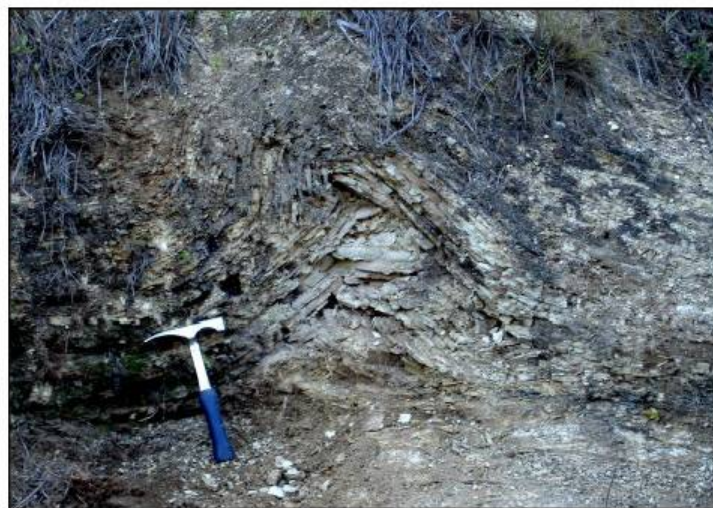
Foto 15: Dobra com atitude do eixo N286/05 observada no talude sudoeste do trecho 3.
