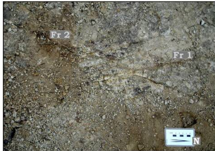
Foto 18: Zona de cisalhamento observada em planta do trecho 4. Fr1-N20W/90 e Fr2-N10E/50SW.
