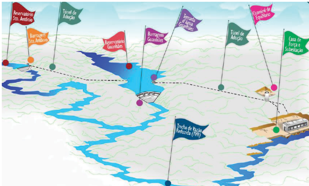
Figura 32 – Arranjo UHE Salto Grande
