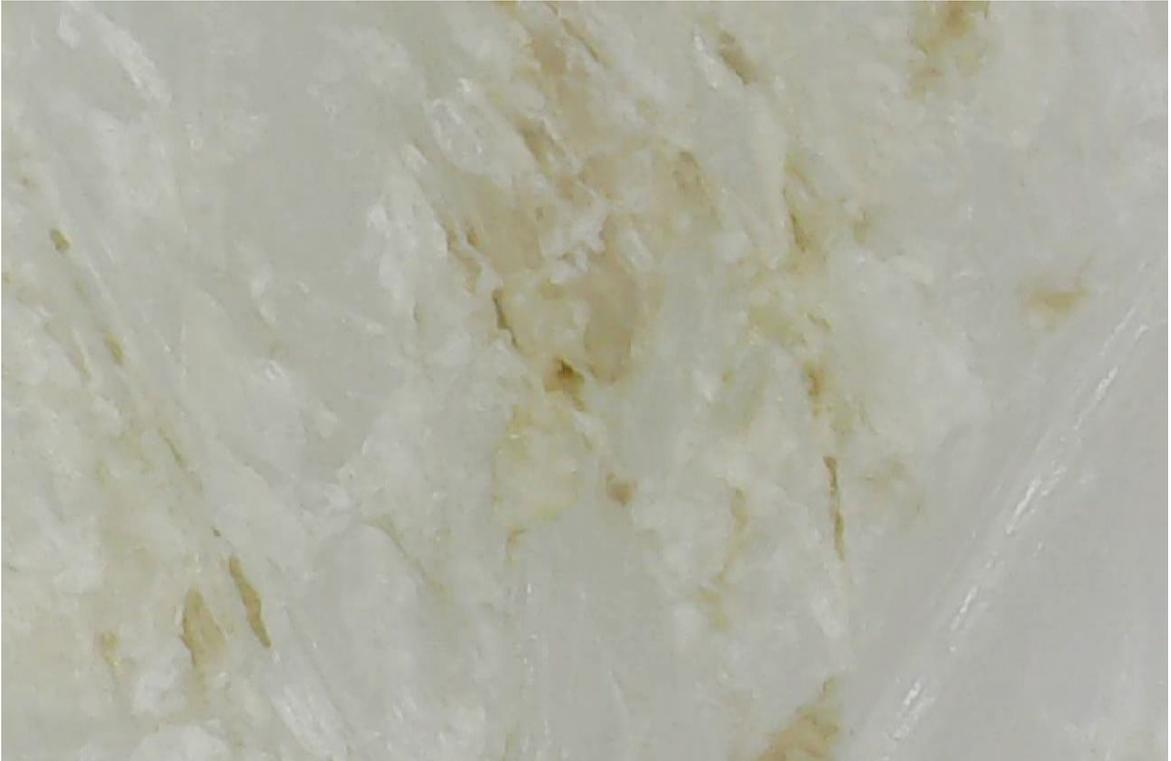
**Figura 8** – Superfície de corte de material polietileno do supermercado F, evidenciando profundas ranhuras e sulcos presentes ao longo da superfície. (Equipamento: lupa digital portátil com ampliação ótica de 1000x).
