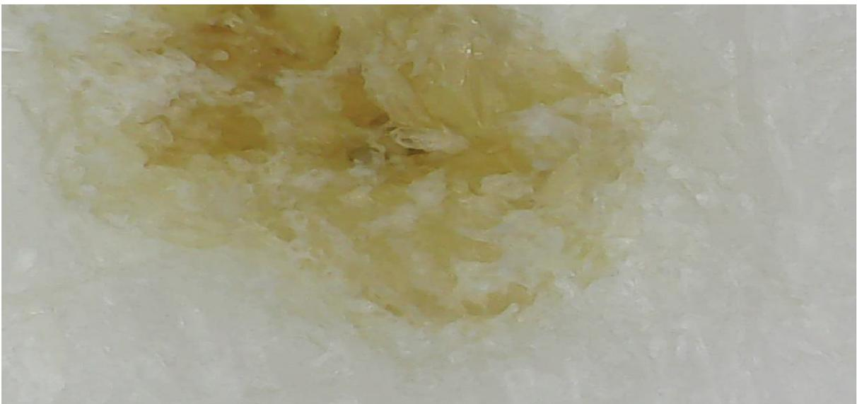
**Figura 7** – Superfície de corte de material polietileno do supermercado E, evidenciando profundas ranhuras e sulcos presentes ao longo da superfície. (Equipamento: lupa digital portátil com ampliação ótica de 1000x).
