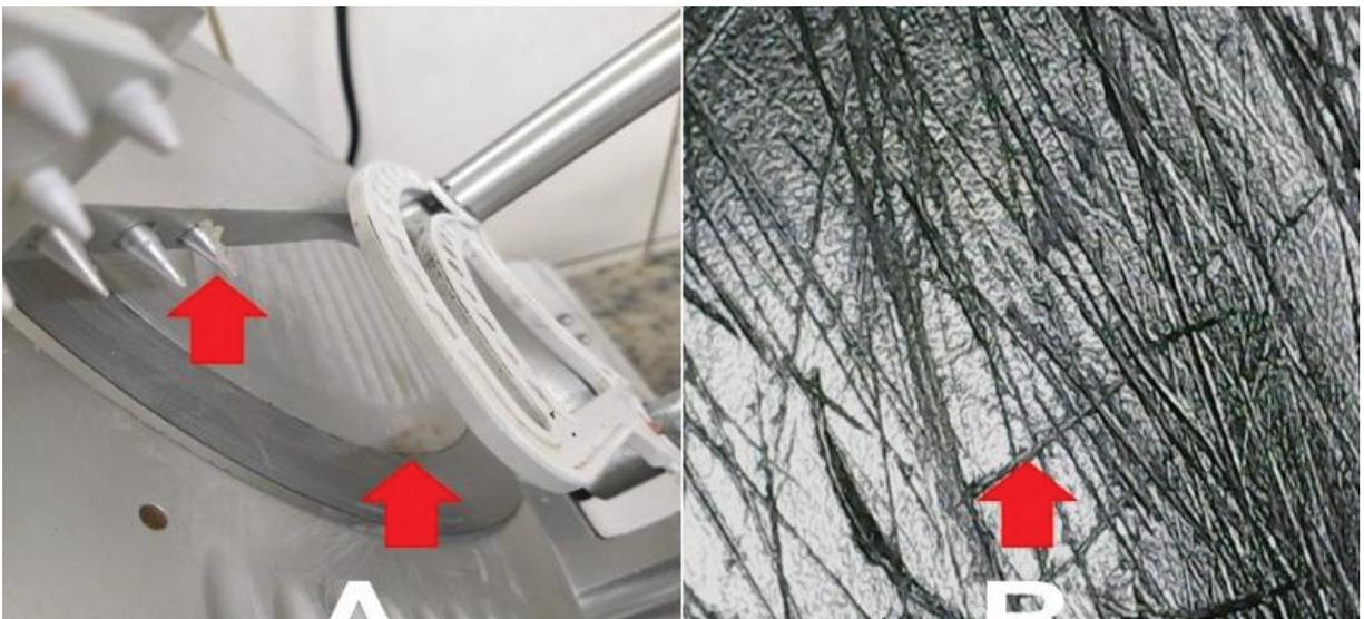
**Figura 3** – Fatiador de frios de material inoxidável do supermercado E. Na figura A, as flechas vermelhas indicam presença de matéria orgânica remanescente, observada em todas as coletas. Na figura B é possível observar inúmeros riscos presentes em toda superfície. (Equipamento: lupa digital portátil com ampliação ótica de 1000x).
