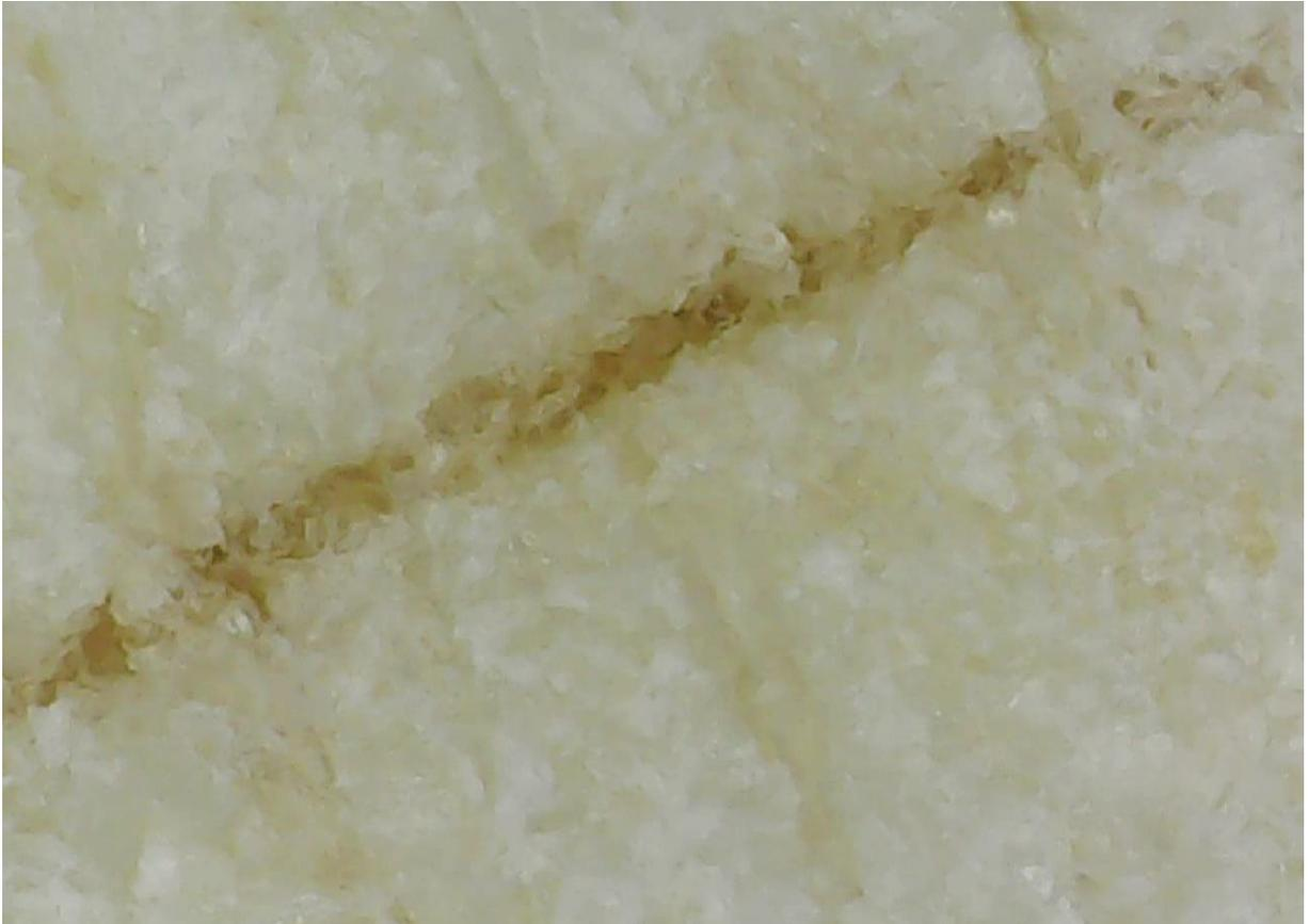
**Figura 5** – Superfície de corte de material polietileno do supermercado E, evidenciando profundas ranhuras e sulcos presentes ao longo da superfície. (Equipamento: lupa digital portátil com ampliação ótica de 1000x).
