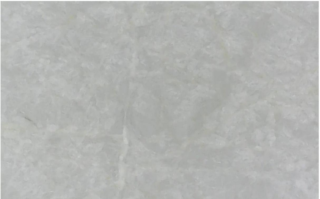
**Figura 9** – Superfície de corte de material polietileno do supermercado C. É possível observar uma menor quantidade de ranhuras quando comparada aos estabelecimentos E e F. (Equipamento: lupa digital portátil com ampliação ótica de 1000x).
