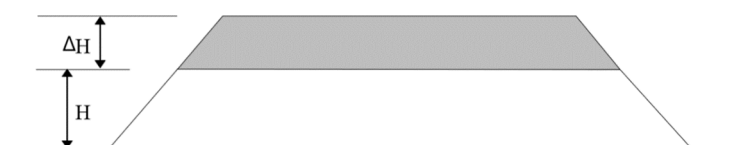
FIGURA 5 - CONSTRUÇÃO POR ETAPAS
