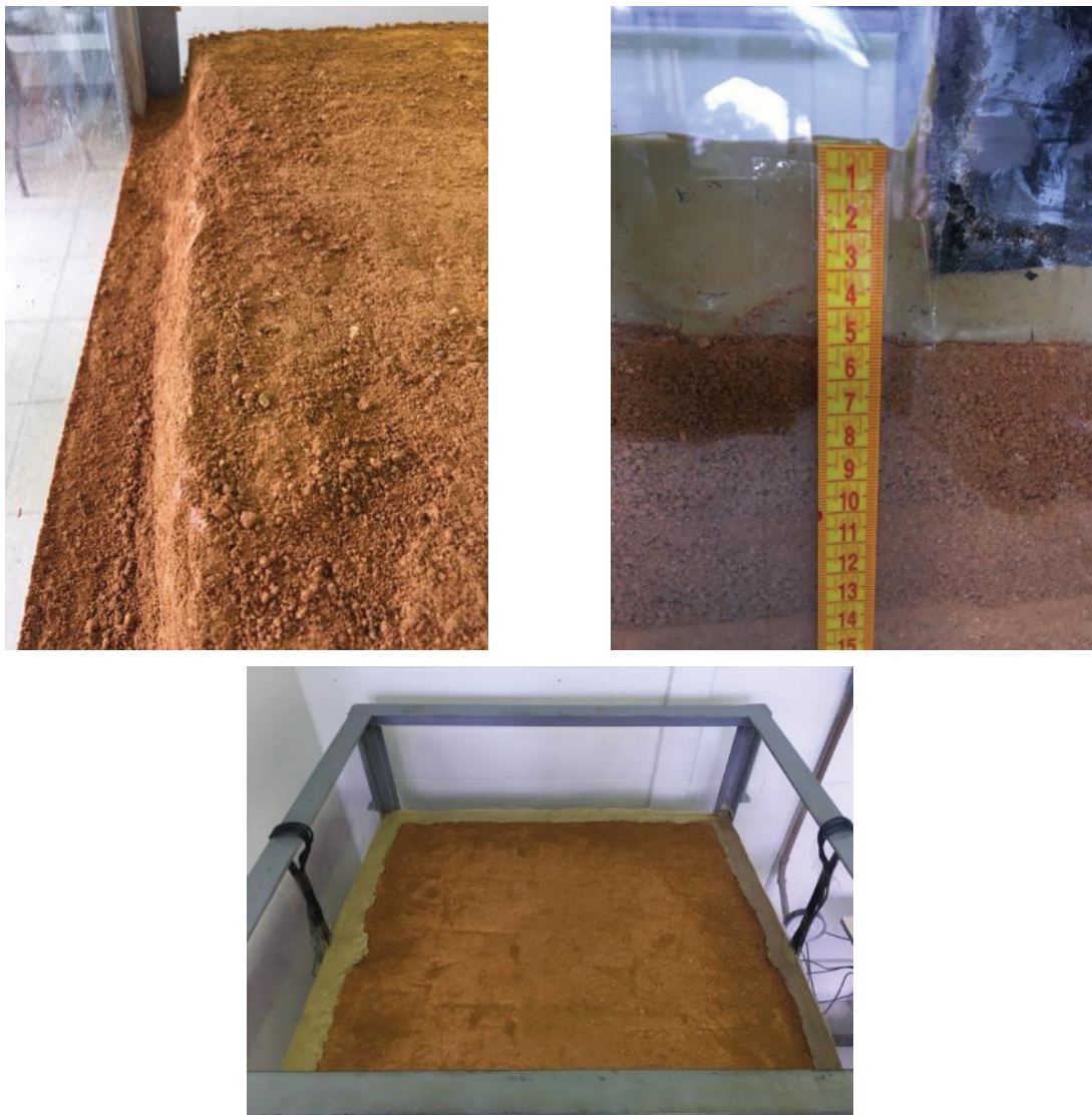
FIGURA 30 – APLICAÇÃO DE BENTONITA NA INTERFACE SOLO ACRÍLICO
