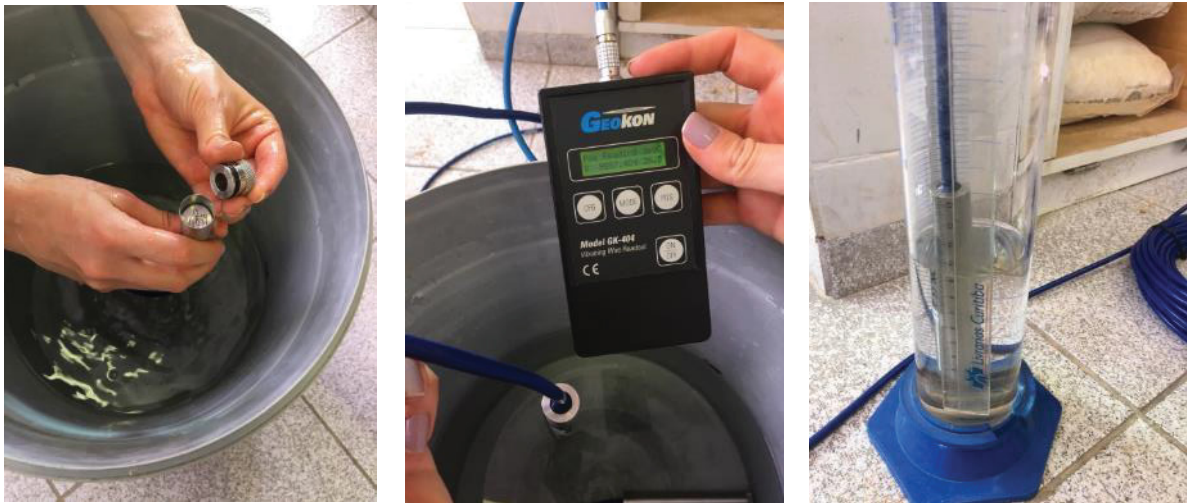
FIGURA 36 – PROCEDIMENTOS DE INSTALAÇÃO DOS PIEZÔMETROS
