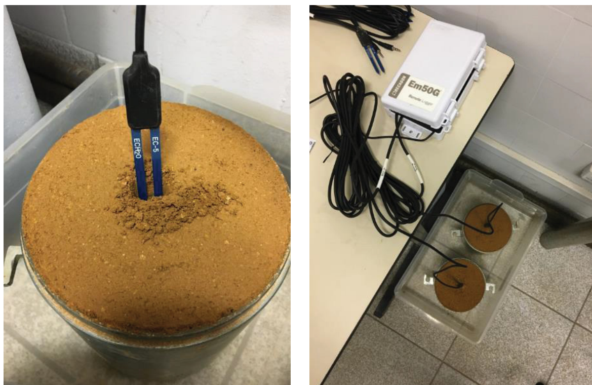
FIGURA 40 – CALIBRAÇÃO DOS SENSORES DE UMIDADE
