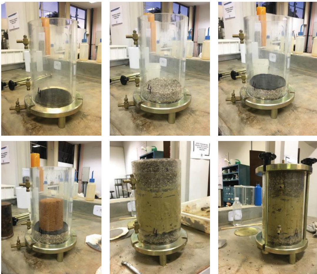
FIGURA 26 – SEQUÊNCIA DE MONTAGEM DO PERMEÂMETRO
