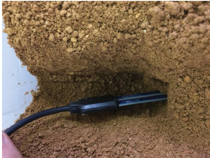
FIGURA 39 – INSTALAÇÃO DO SENSOR DE UMIDADE
