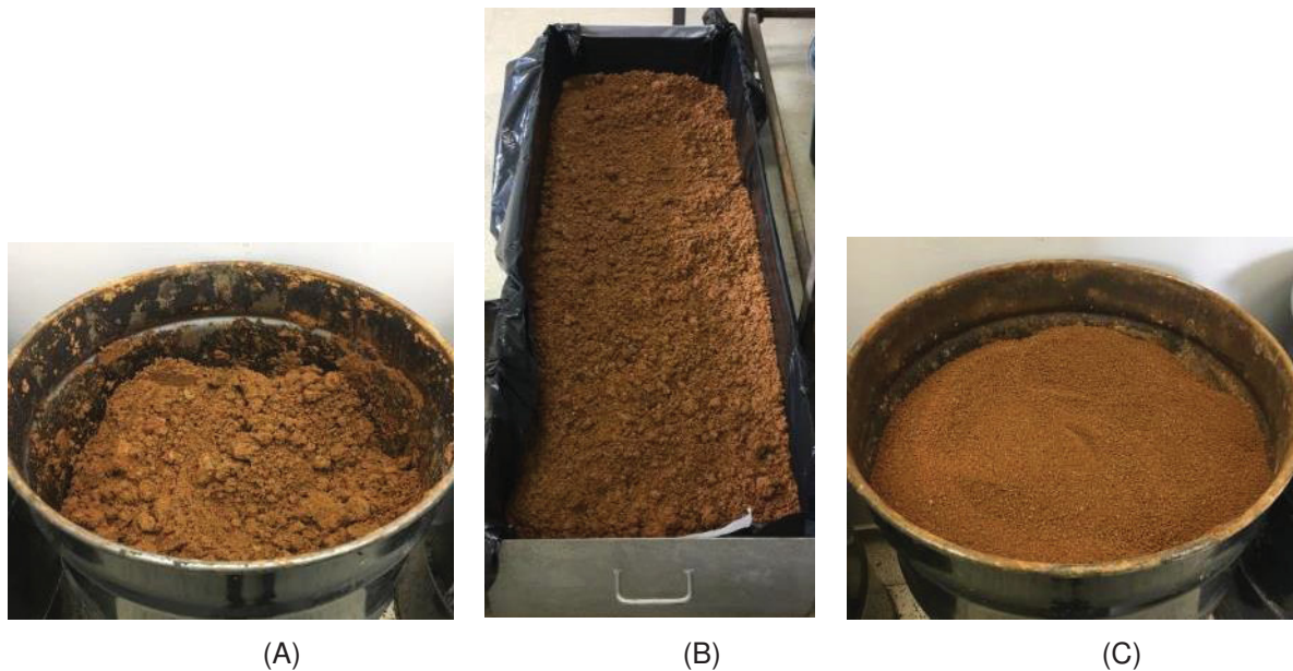
FIGURA 17 – PREPARAÇÃO DO SOLO: (A) SOLO COLETADO, (B) PROCESSO DE SECAGEM E (C) SOLO UNIFORMIZADO
