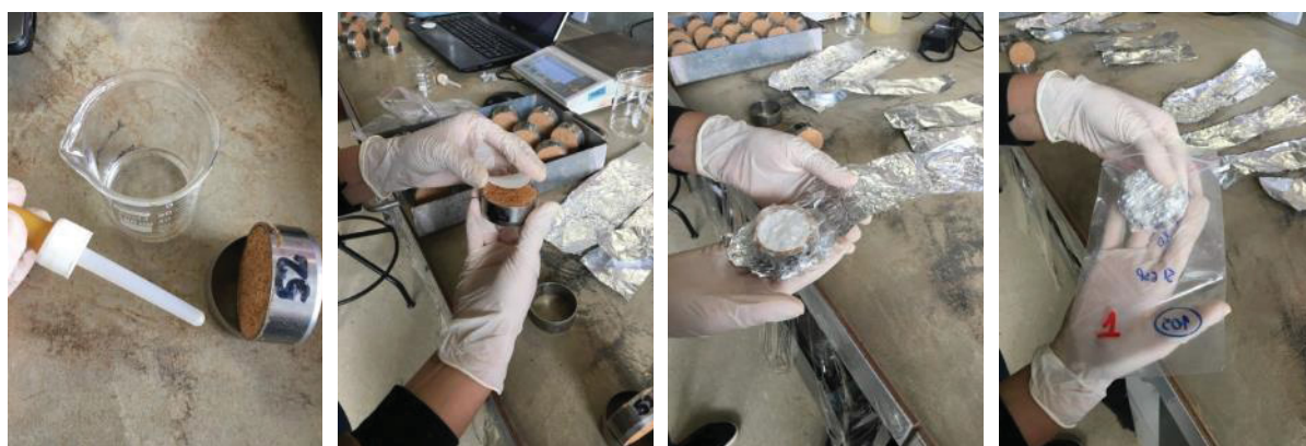
FIGURA 23 – PROCEDIMENTOS DO ENSAIO DO PAPEL FILTRO
