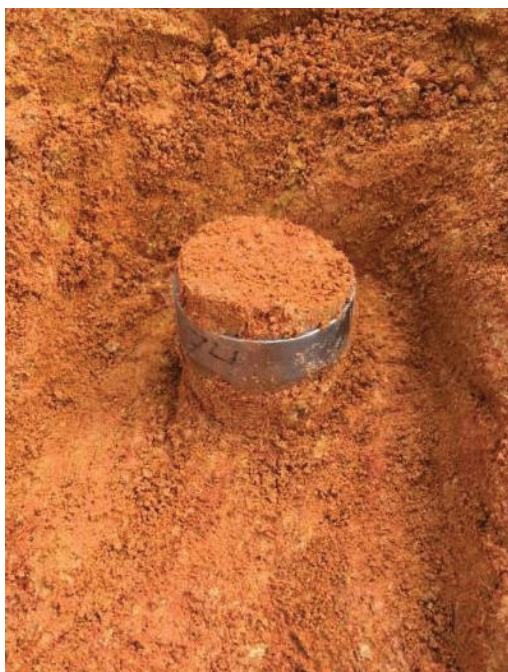
FIGURA 21 – COLETA DE AMOSTRA INDEFORMADA PARA DETERMINAÇÃO DE ÍNDICES FÍSICOS
