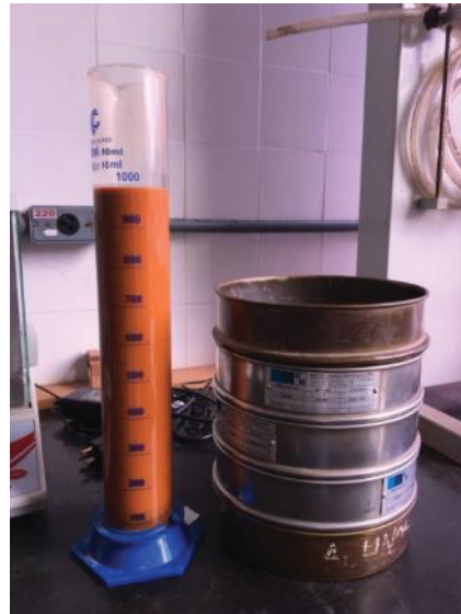
FIGURA 18 – ENSAIO DE SEDIMENTAÇÃO E PENEIRAMENTO
