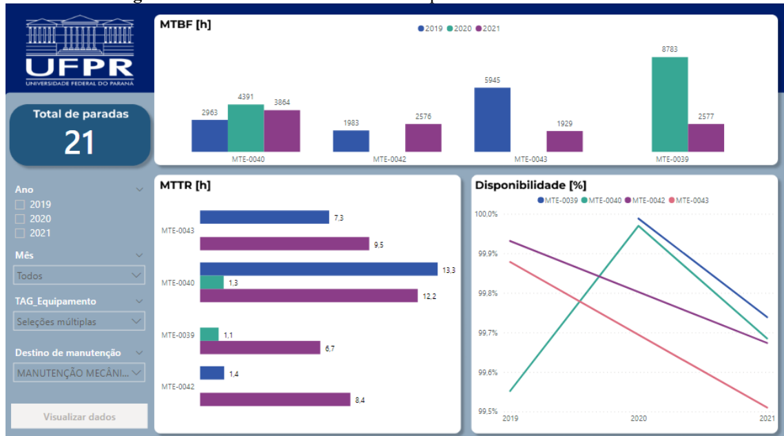
Figura 24 – Análise das falhas mecânicas para família de motores elétricos.
