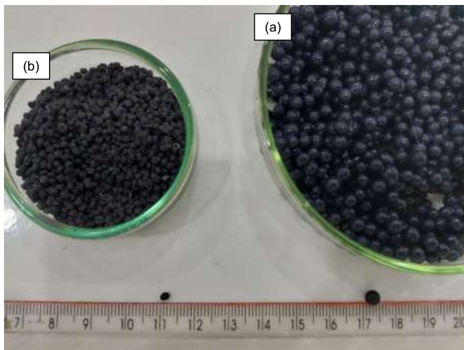
Figura 6 – Carvão ativado encapsulado (a) antes e (b) depois da secagem em estufa.
