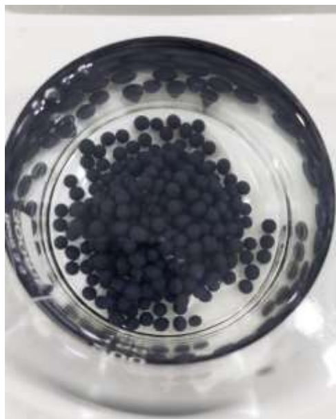
Figura 4 – Esferas de carvão de casca de laranja em solução de cloreto de cálcio.
